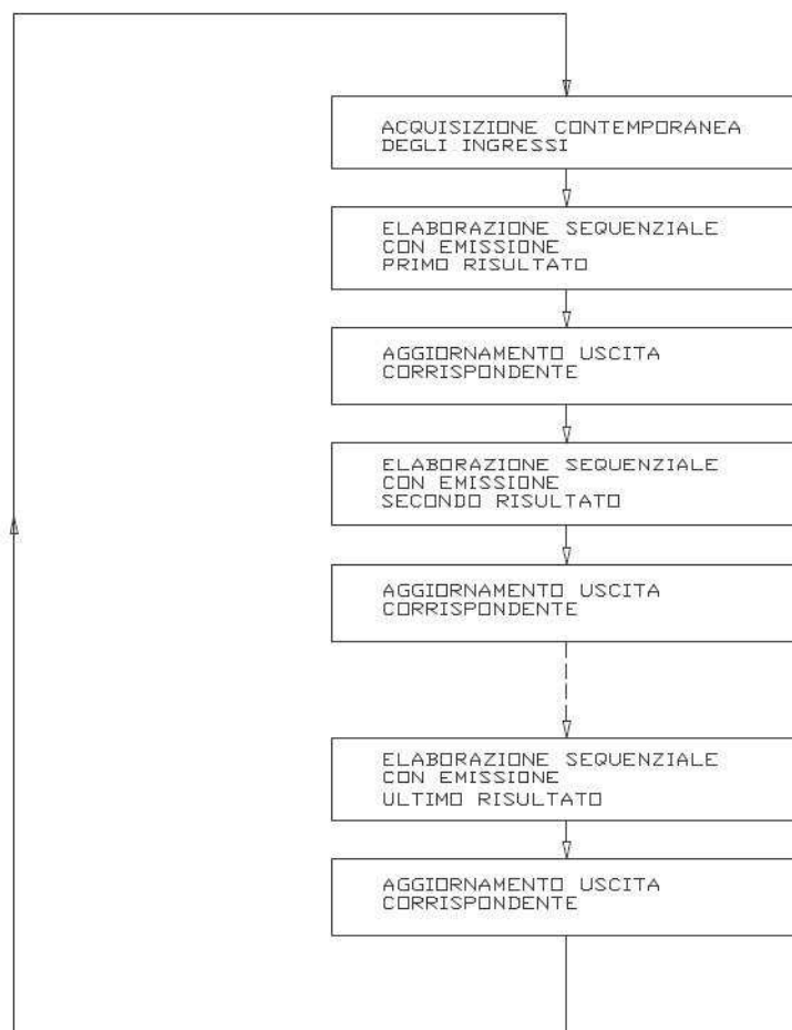
Figura 2.3: Fasi di un ciclo sincrono in ingresso e asincrono in uscita.
