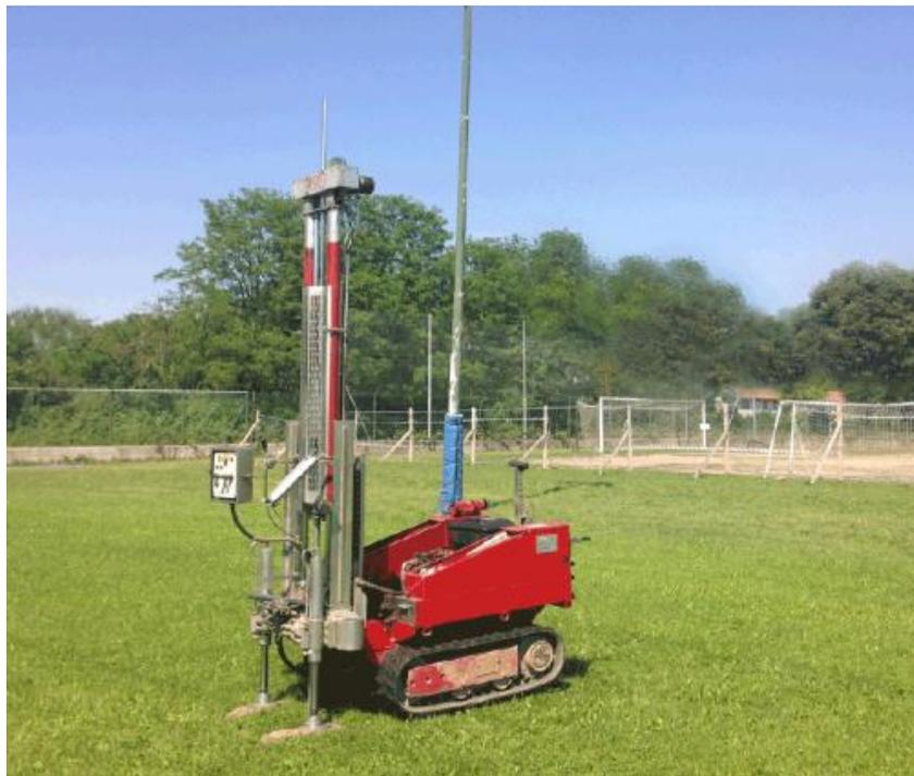
*Figura 13-Esempio di carotiere utilizzato per le prove CPT*
