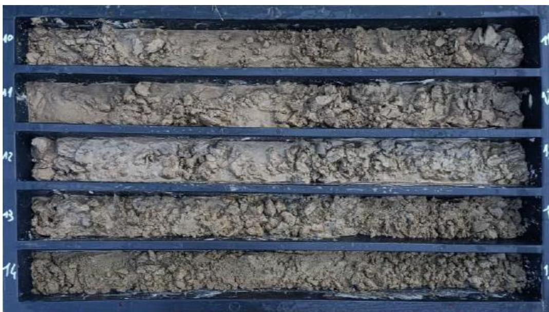
*Figura 14-Esempio di cassetta, profondità da m 10.00 a m 15.00*
