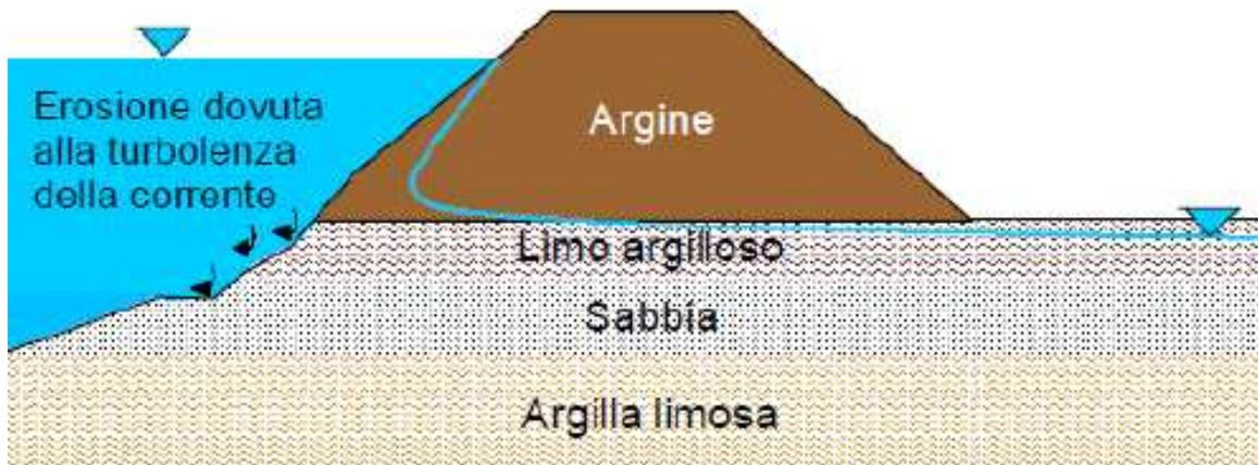
Figura 5-Erosione esterna lato alveo, (P.Simonini-S.Cola-S.Bersan, 2014)
