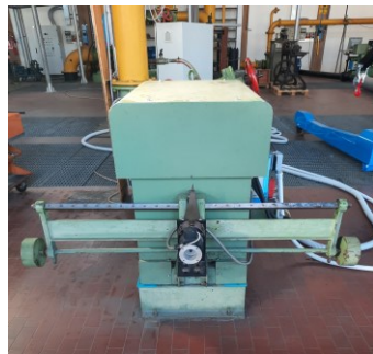
Bilanciere per la misura della coppia
