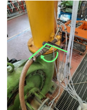
Apertura rubinetto pompa a vuoto
