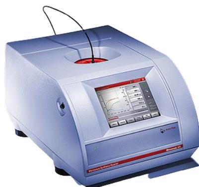
Figura 2.15: Reattore a microonde Anton paar monowawe 300
