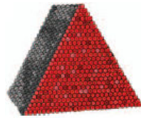
Figura 1.23 HSA approssimata ad un prisma triangolo equilatero.
