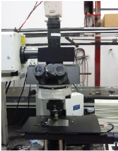
Figura 2.3 Foto dello strumento (a destra) e immagine della testa confocale costituita da: 1) Ingresso fibra ottica; 2) Collimatore; 3) Polarizzatore; 4) Specchio; 5) Specchio dicromatico; 6) Specchi galvanometrici; 7) Ingresso al microscopio con beam expander che ingrandisce il fascio di 3,3; 8) Lenti di raccolta; 9) Torretta dei pinhole ; 10) Selettore dei rivelatori; 11) Filtri; 12) Tubo fotomoltiplicatore. Nel nostro set-up lo specchio 4 è sostituito da un dicroico, e il laser impulsato entra nel sistema attraverso un foro praticato nella parete alle spalle del dicroico stesso.
