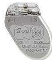
Fig.4.3: pm bicamerale con sensore TVI
