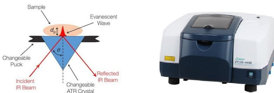
Figura 2.15. Schema di funzionamento spettroscopia FT-IR/ATR (sinistra) e spettroscopio Jasco FT-IR 4200 (destra)
