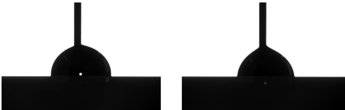
Figura 2.9. Esempi di frame analizzati al software di un angolo di avanzamento (sinistra) e recessione (destra) del campione O2T8-2,5.
