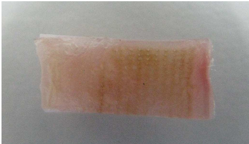
Figura 5-3: tessuto cartilagineo naturale, dopo lavorazione con canali incrociati
