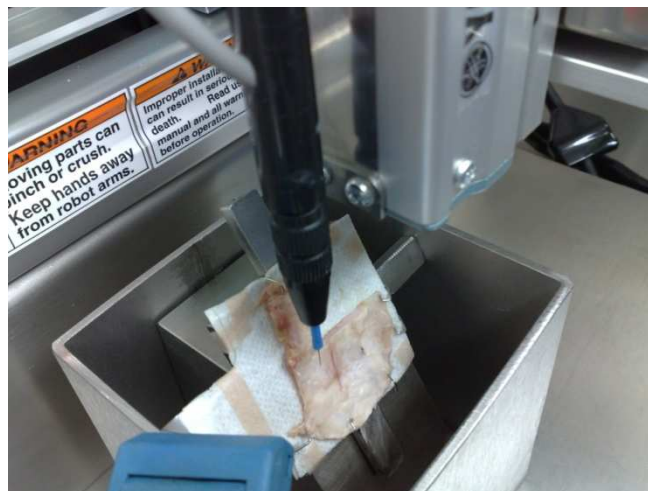
Figura 4-3: piano inclinato su cui appoggia il tessuto cartilagineo, per creare i canali angolati
