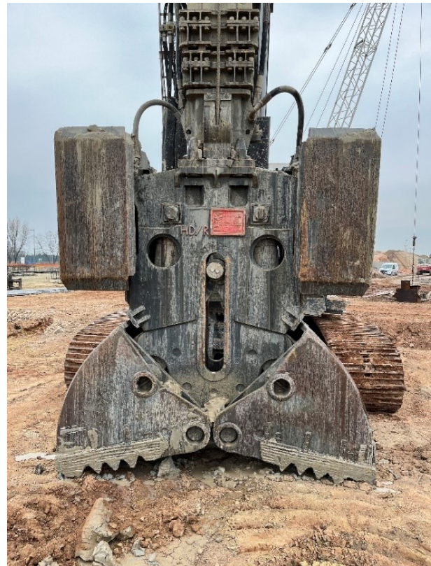
Figura 17: Scavo pannelli di diaframma con gru cingolata Kelly Casagrande C400 e benna mordente, dotata di sensore di misurazione JEAN LUTZ S.A .
