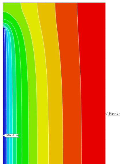
Figura C.3: Modello di validazione 'Prova di emungimento in pozzo 2D assialsimmetrico' – TOTAL HEAD [m].
