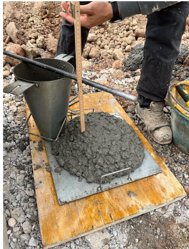
Figura 22: Fase di getto del diaframma in calcestruzzo e risultato della prova con il cono di Abrams per definire la classe di lavorabilità del calcestruzzo.
