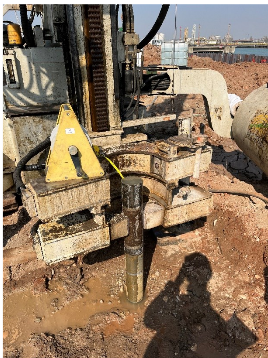
Figura 32: Esecuzione prova di permeabilità in sito Lefranc per la determinazione del coefficiente di permeabilità.
