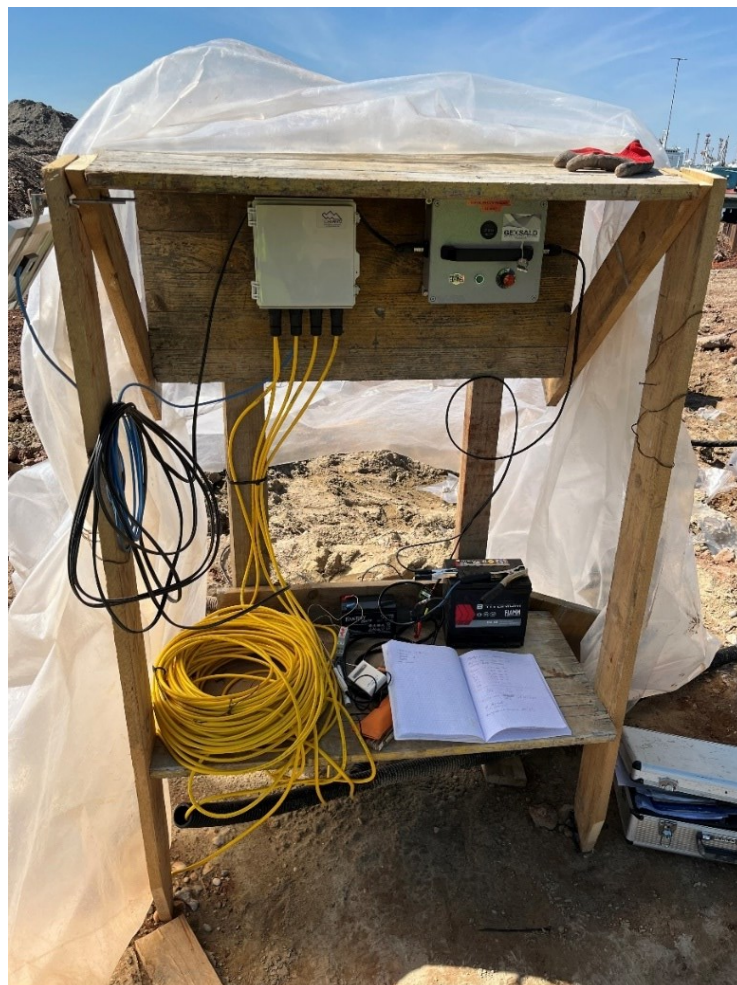
Figura 27: Postazione del campo prove per la sistemazione degli strumenti elettronici necessari alla realizzazione e alla raccolta delle misure.
