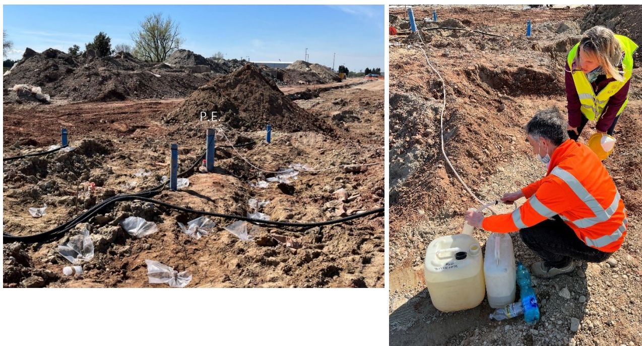
Figura 28: Immagine del pozzo di emungimento, predisposto con all'interno la pompa, e del tubo di scarico della portata emunta verso un cilindro graduato e delle taniche di volume noto.
