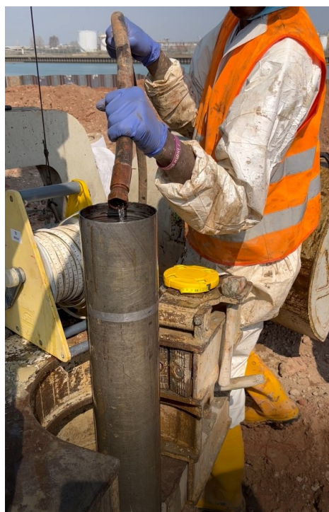
Figura 32: Esecuzione prova di permeabilità in sito Lefranc per la determinazione del coefficiente di permeabilità.
