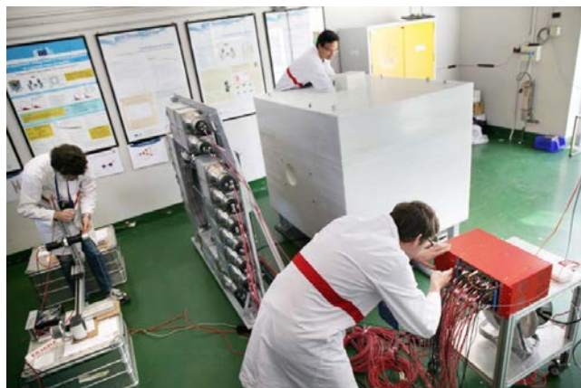
Figura 6.4: Test di integrazione del TNIS: da sinistra a destra rispettivamente, la guida, il sistema di rivelazione e il generatore di neutroni dentro alla schermatura di polietilene [B19].
