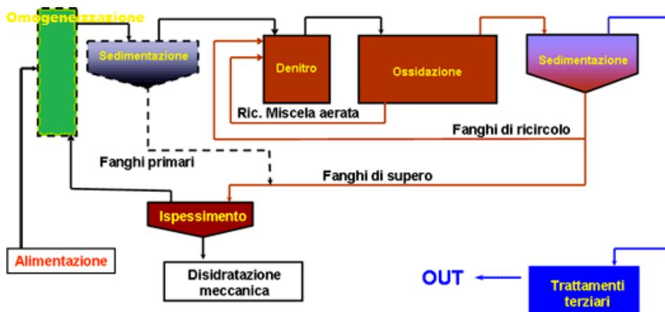
*Figura 2.2 Schema generico di un impianto di depurazione di acque reflue (Bonomo, 2008)*
