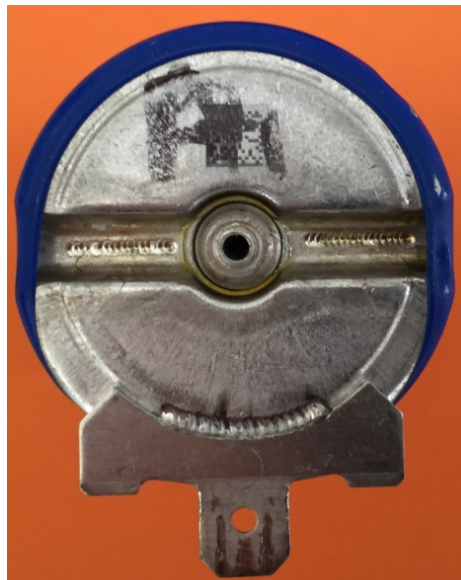
Figura 11 – Perdite di acetonitrile dopo 500h di invecchiamento (09190)
