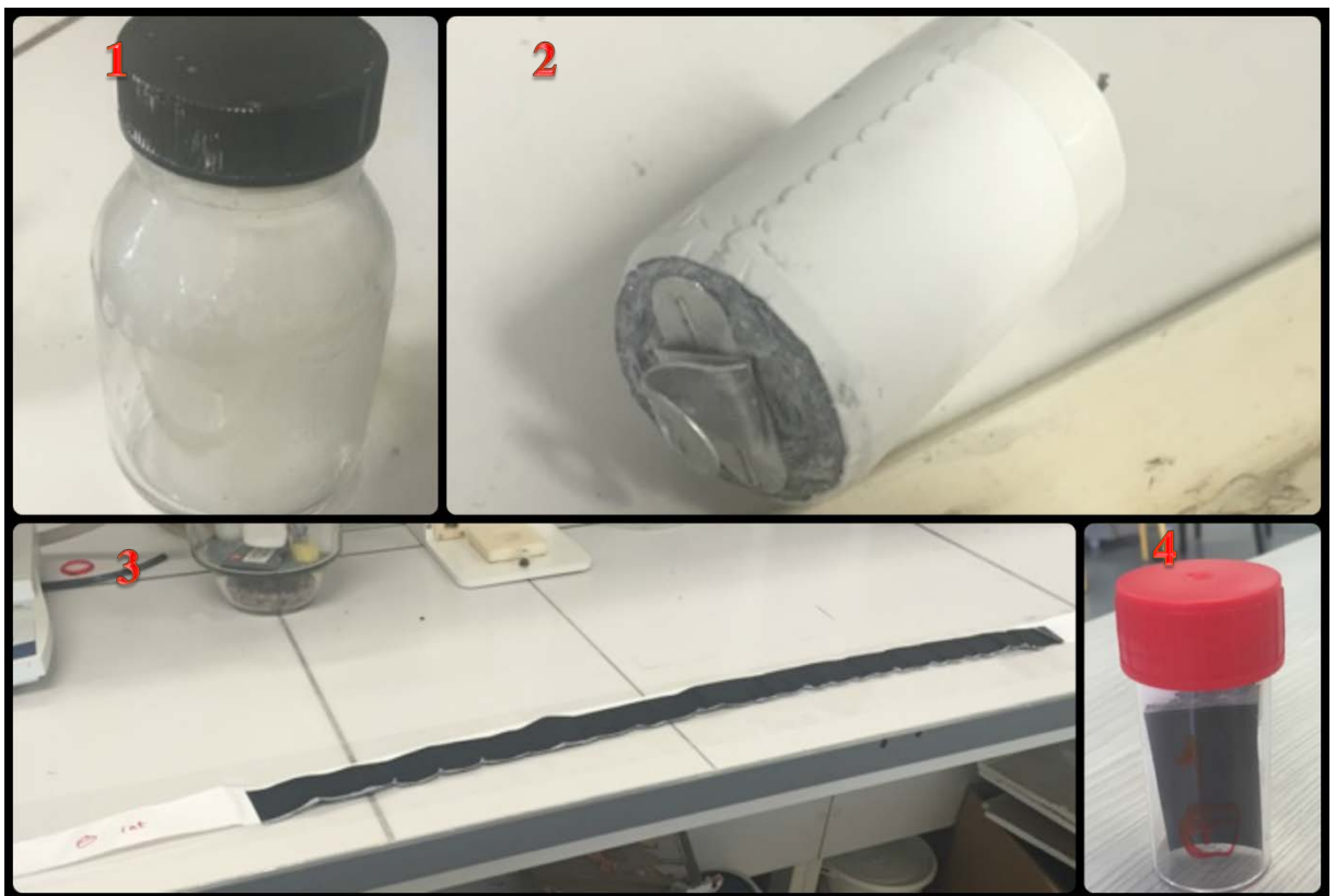
Figura 14 – Le 4 fasi dell'apertura del supercondensatore: 1 - Il becher con l'acetonitrile; 2 – Il supercondensatore senza copertura metallica; 3 – L'elettrodo srotolato; 4 – Un campione di elettrodo tagliato.
