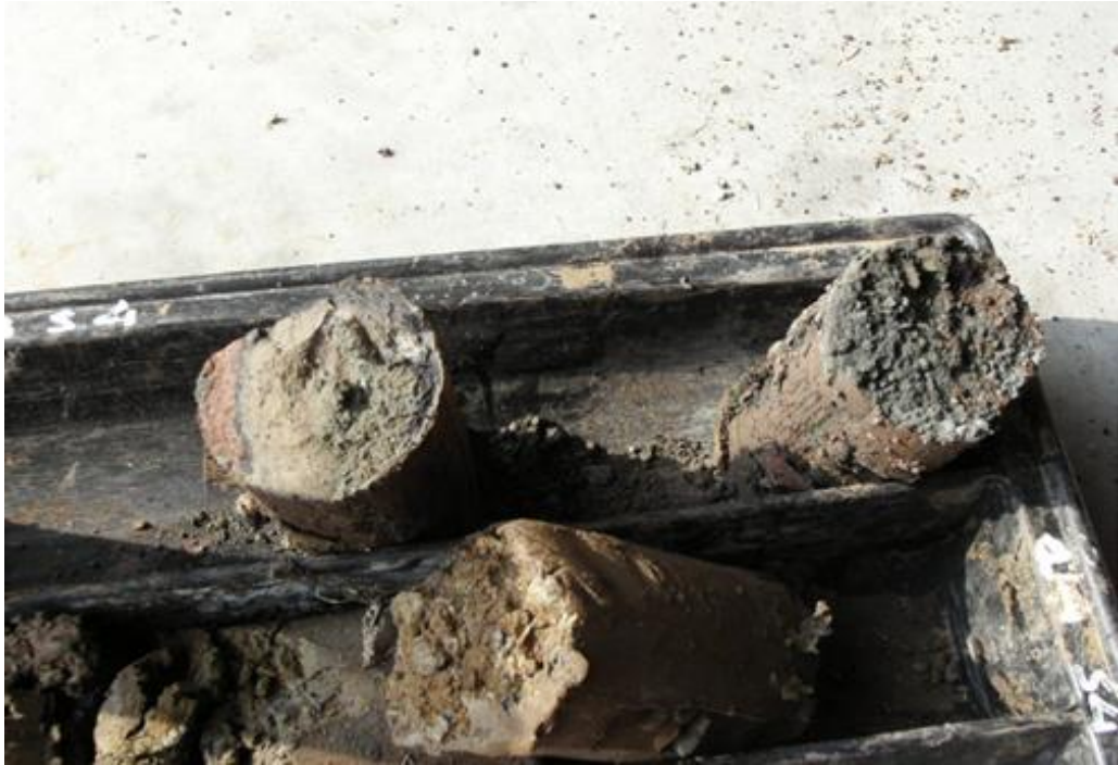
Foto 11 – Dettaglio del pietrisco basaltico in matrice tufacea debolmente alterata presente da - 6 m a - 13.5 m. Ubicazione in Figura 26.
