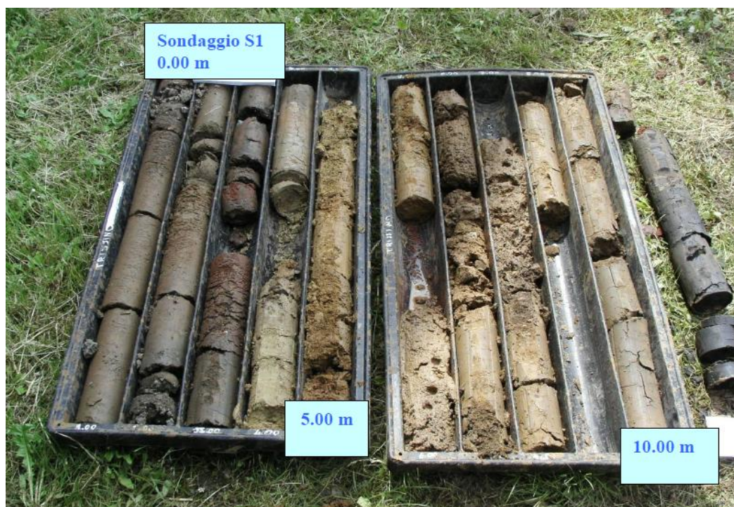
Foto 9 – Sondaggio S1 dal piano campagna a - 11 m. Ubicazione in Figura 26.
