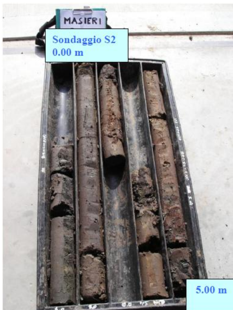
Foto 10 - Sondaggio S2 dal piano campagna a – 5 m. Ubicazione in Figura 26.
