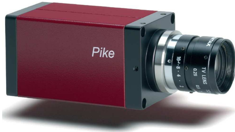
Figura 4.8: Telecamera a matrice AVT Pike F-032 utilizzata per il nostro sistema di visione
