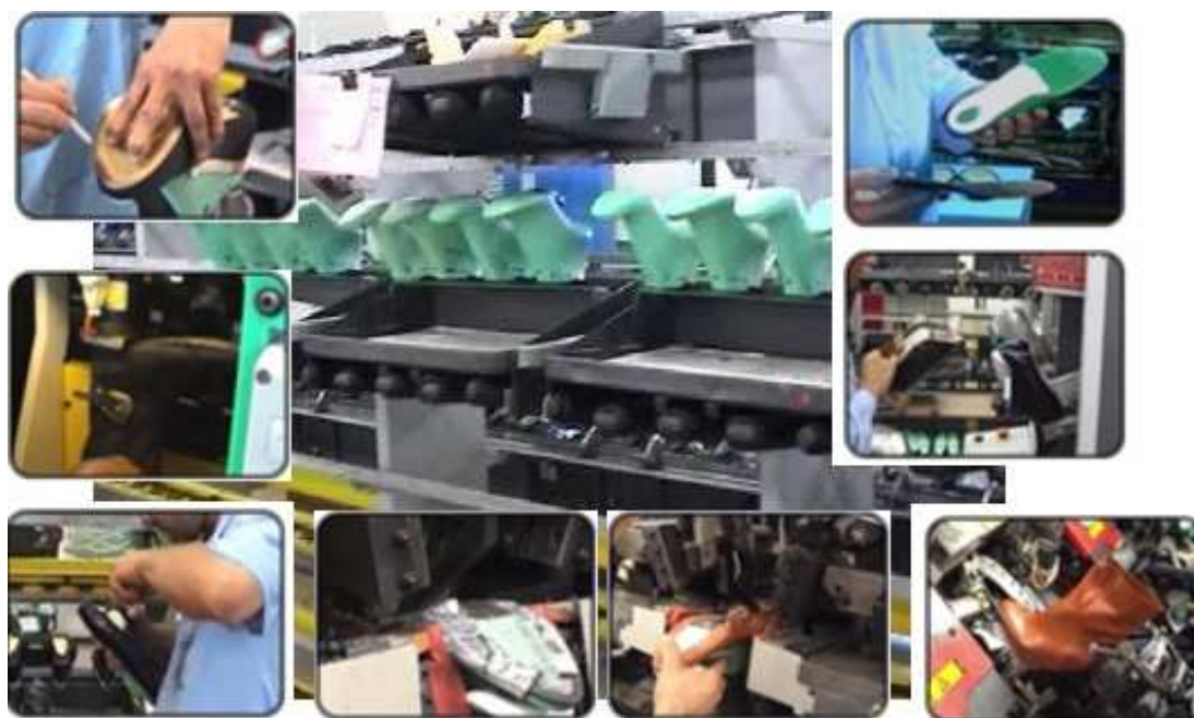
Figura 1.2: Sullo sfondo un esempio di manovia costituita da una giostra multilivello. Poi una serie di lavorazioni standard quali (partendo da in alto a destra) applicazione del sottopiede, inserimento del puntale e contrafforte, premonta e monta, montafianchi, monta boetta, levachiodi ribattitura dei chiodi fissati in fasi precedenti e tracciatura
