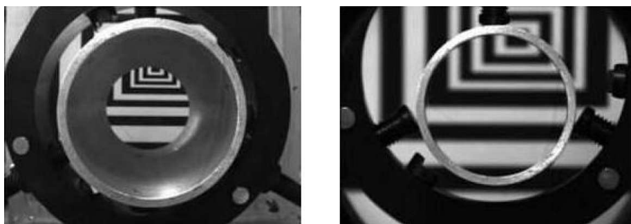
Figura 2.7: Confronto tra ottica standard entocentrica ed ottica telecentrica
