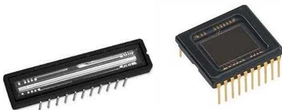
Figura 2.10: (a) sensore lineare; (b) sensore matriciale
