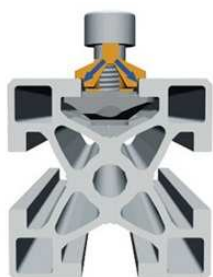
Figura 4.1: Disegno di un profilo di profilato Robotunits.
