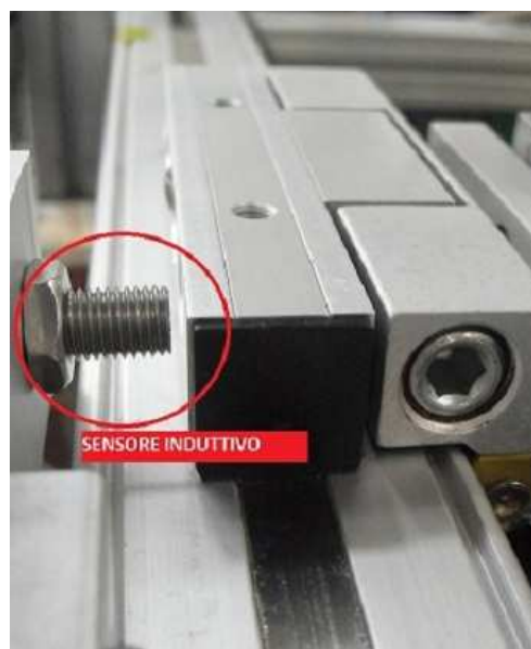
Figura 4.11: Particolare del carrello guida in prossimità di uno dei due sensori induttivi.
