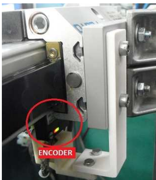
Figura 4.10: Particolare del sistema di visione per evidenziare la posizione dell'encoder lineare.
