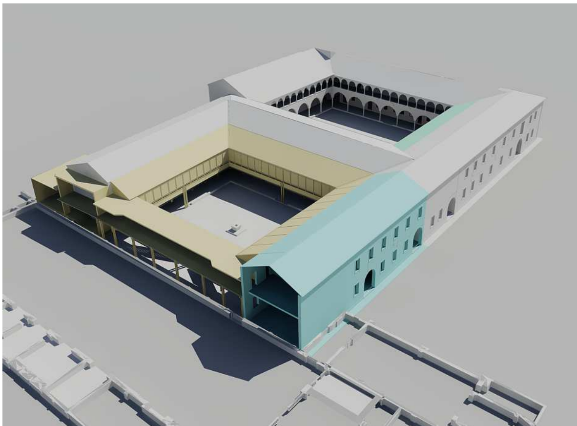
Fig.[5.29] Come appare oggi il Chiostro Minore, con la struttura in acciaio (in giallo) e il braccio est (di color ciano) ricostruito dopo i restauri.
