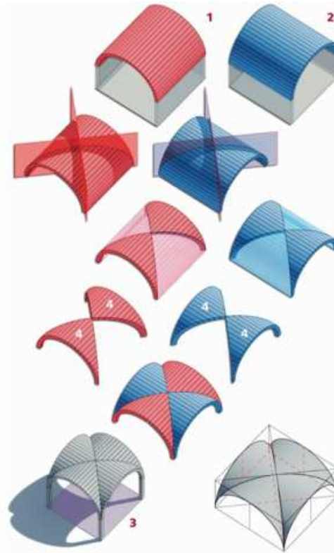
Fig.[3.4] Composizione volta a crociera.
