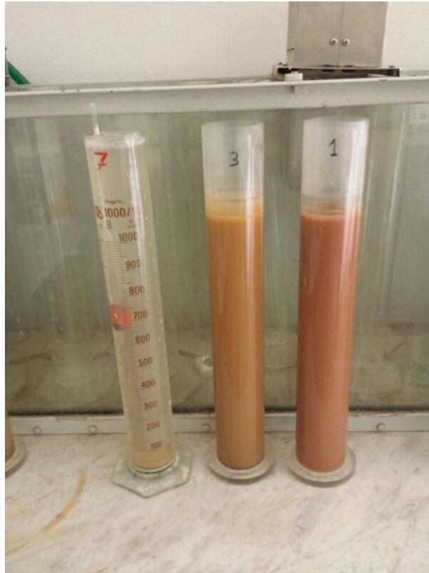
Figura 59 Prove di aerometria: al centro bentonite A, a sinistra bentonite B.
