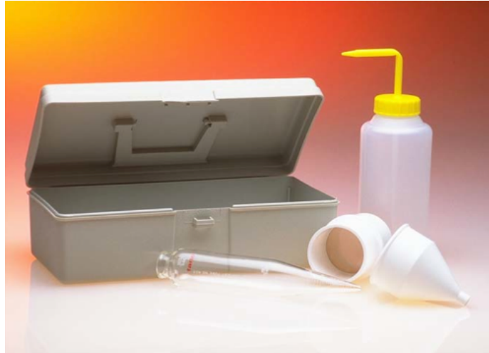
Figura 42 Kit per la misurazione del contenuto in sabbia (fonte Fann.com).
