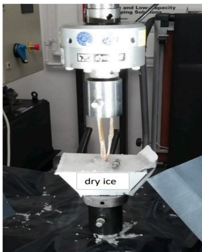
Fig. 18- Sistema di misurazione: Un'estremità del tendine stabilizzata da morsetti e ghiaccio secco, l'altra fissata tramite un albero metallico. [20]
