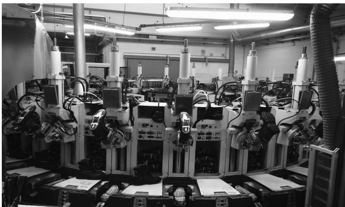
Figura 2.2: Macchina rotativa o giostra per l'iniezione diretta su tomaia di soles in PU (24 stazioni)
