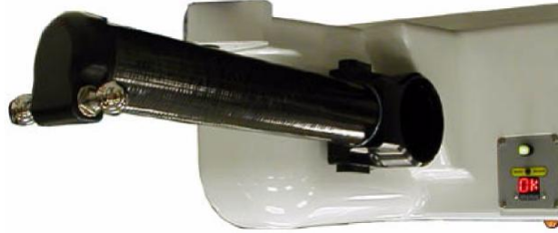
Figura 4: Particolare dell'accoppiamento tra telaio e manovella dell'Adept Quattro™
