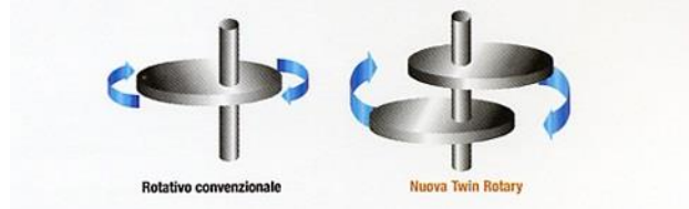
Figura 4.7: Confronto tecnologia rotary e twin rotary
