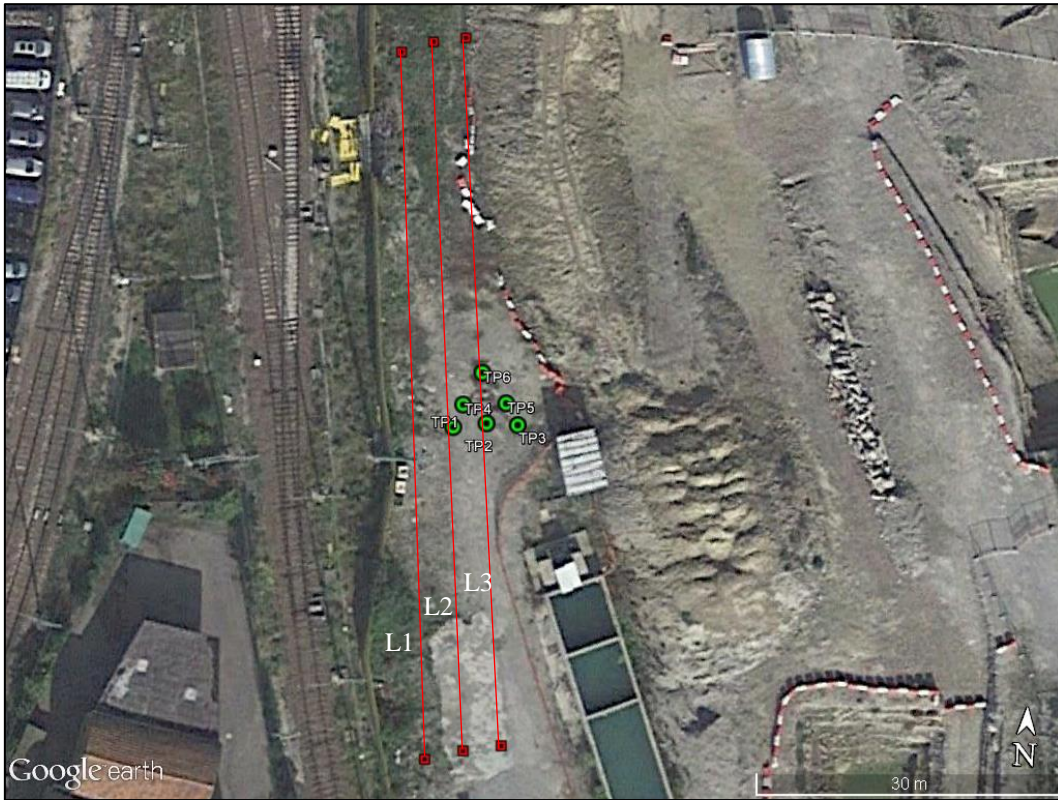
fig. 3.14 posizione dei pozzetti usati durante i pre – test, insieme agli stendimenti evidenziati dalle linee rosse..
