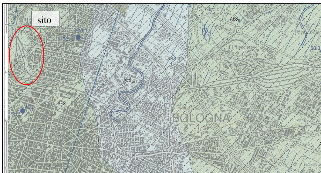
fig. 3.8 porzione del foglio CARG 221 - Bologna dell'area della città, con indicato la zona del sito. Come indicato dalla legenda, la città giace su terreni di natura alluvionale e di età quaternaria.
