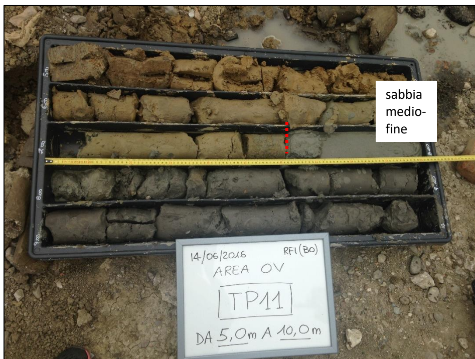
fig. 3.4 nella fotografia è presente il contenitore del materiale prelevato tra 5 - 10 m.d.p.c. Foto: Regensis.
