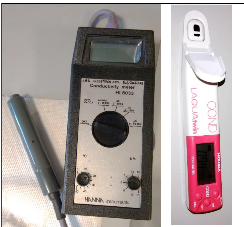
fig. 3.20 a sinistra il conduttivimetro Hanna, a destra il conduttivimetro di fabbricazione della Horiba.
