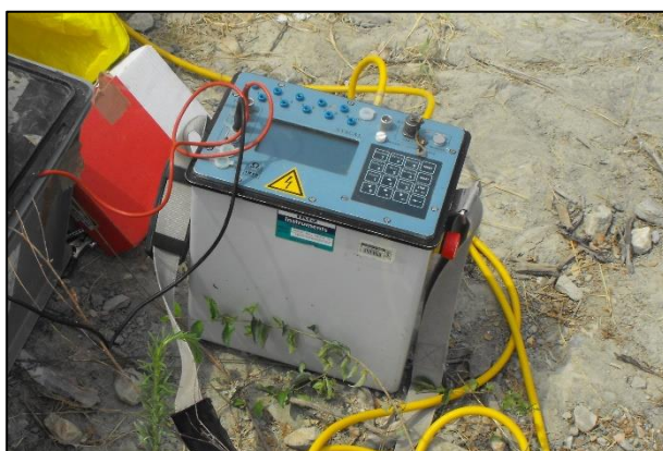
fig. 3.16 Georesistivometro IRIS Syscal Pro 72, strumento utilizzato per questo lavoro.
