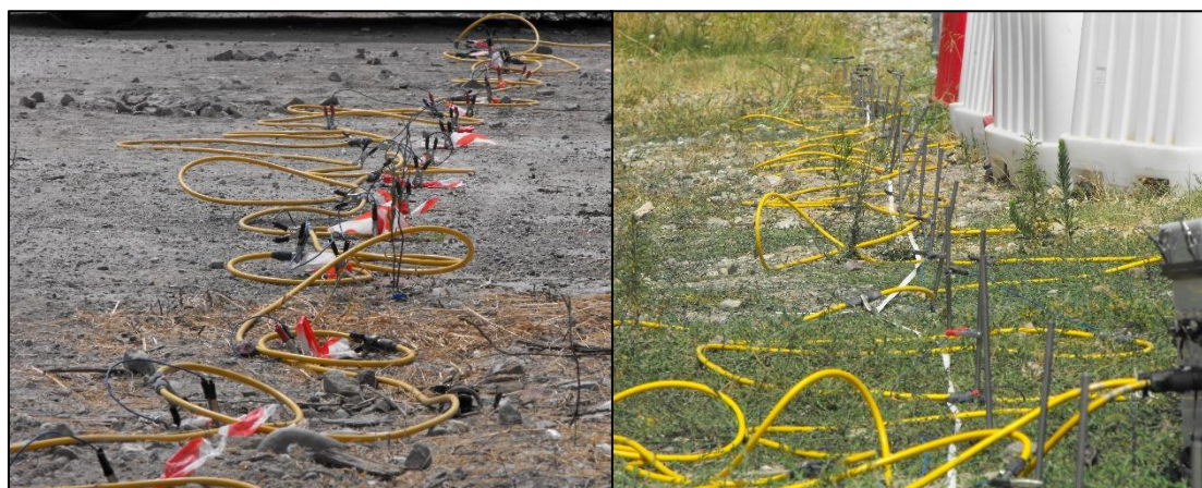
fig. 3.18 a sinistra, linea L2 canale 48-72, elettrodi fissi all'interno dell'asfalto. A destra linea L3, con elettrodi differenti che vengono posizionati durante la giornata di acquisizione dati.
