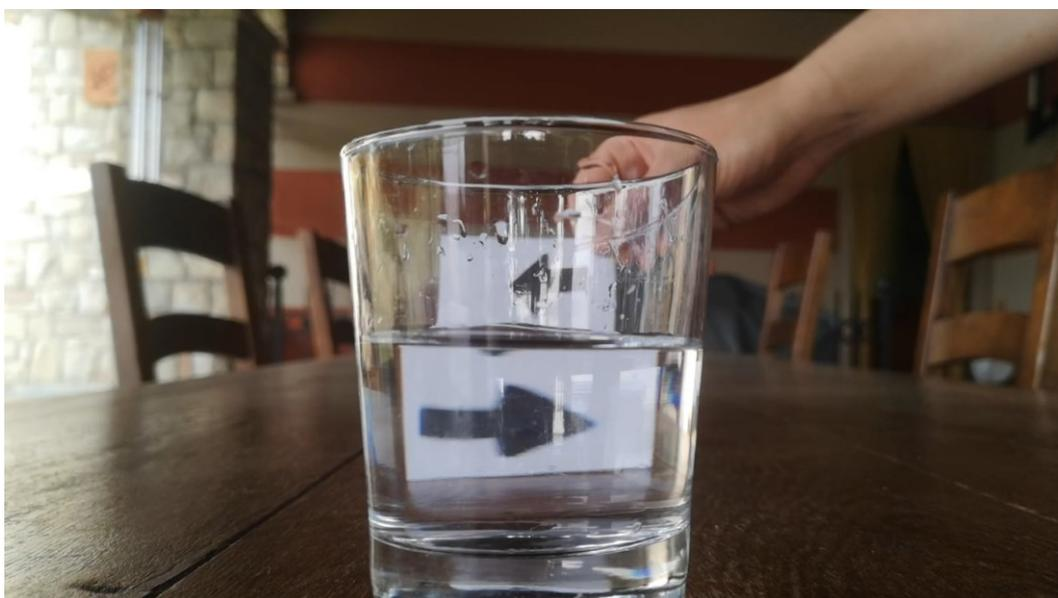
figura 58. Terzo esperimento sulla rifrazione. L'immagine, tratta dal video realizzato dall'insegnante, mostra le due frecce disegnate e orientate verso sinistra che vengono posizionate dietro al bicchiere pieno d'acqua. Quando il foglio viene allontanato, attraverso l'elemento naturale, è possibile vedere le frecce che invertono la direzione. Questo perché, utilizzando un bicchiere di forma cilindrica la luce passa attraverso una superficie curva, la quale funziona come una lente.
