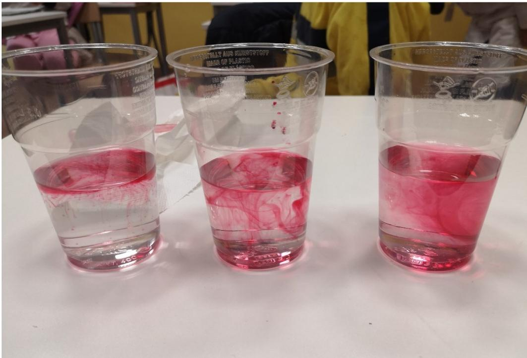
*figura 50.* Esperimento sulla diffusione in classe III AB. Da sinistra a destra: il bicchiere con acqua mantenuta a bassa temperatura all'interno di una borsa termica, il bicchiere con acqua a temperatura ambiente presa dal rubinetto del bagno e il bicchiere con acqua scaldata con l'ausilio di un bollitore elettrico con del colorante alimentare rosso.
