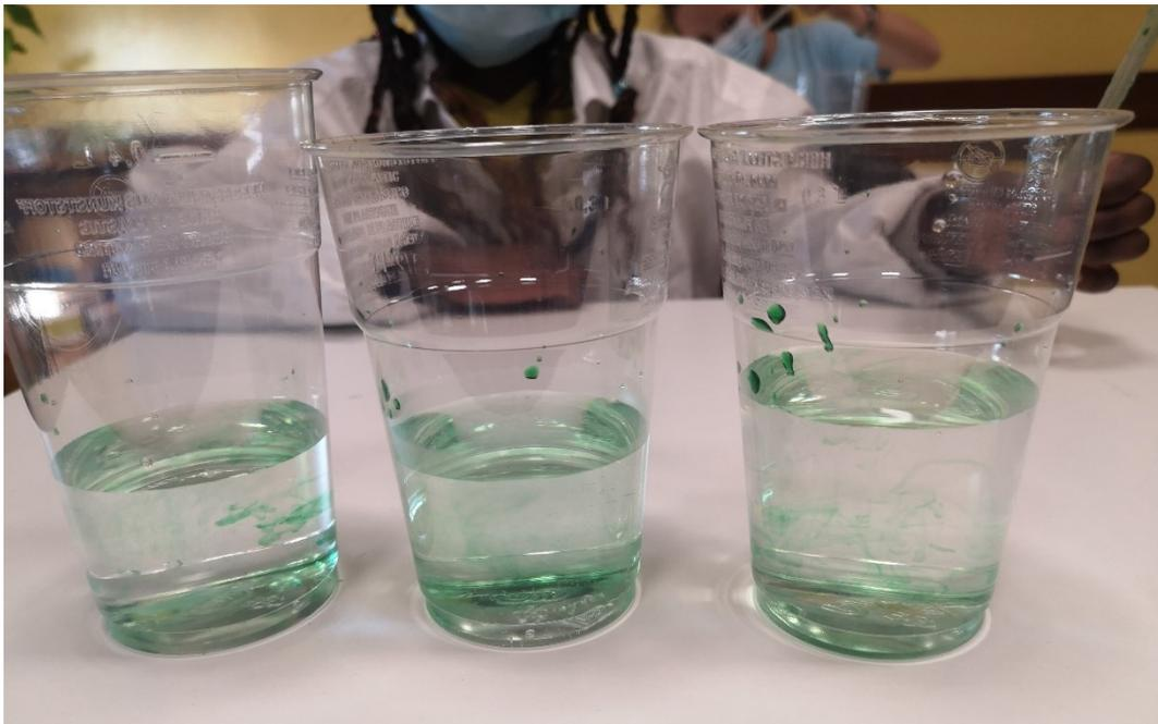
*figura 52.* Esperimento sulla diffusione fallito in classe III B. Da sinistra a destra: il bicchiere con acqua mantenuta a bassa temperatura all'interno di una borsa termica, il bicchiere con acqua a temperatura ambiente presa dal rubinetto del bagno e il bicchiere con acqua scaldata con l'ausilio di un bollitore elettrico con del colorante alimentare verde.
