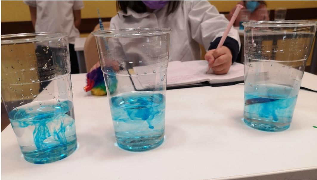
*figura 51.* Esperimento sulla diffusione in classe III B. Da sinistra a destra: il bicchiere con acqua mantenuta a bassa temperatura all'interno di una borsa termica, il bicchiere con acqua a temperatura ambiente presa dal rubinetto del bagno e il bicchiere con acqua scaldata con l'ausilio di un bollitore elettrico con del colorante alimentare blu.
