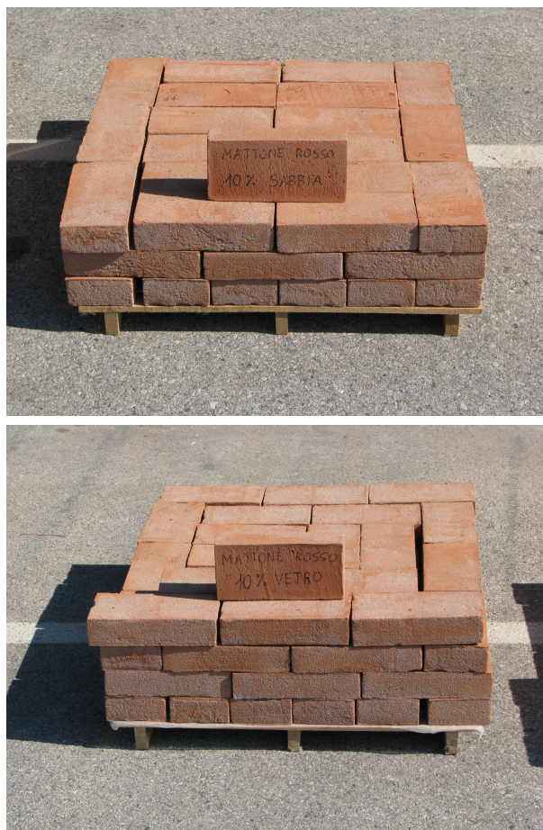
Figura 3.7: Alcuni dei mattoni realizzati per la prova industriale su larga scala.
