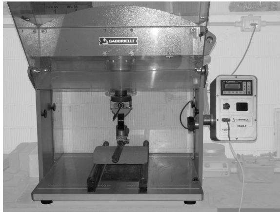
Figura 2.5: Macchina per determinare il carico di rottura trasversale (prova di flessione).
