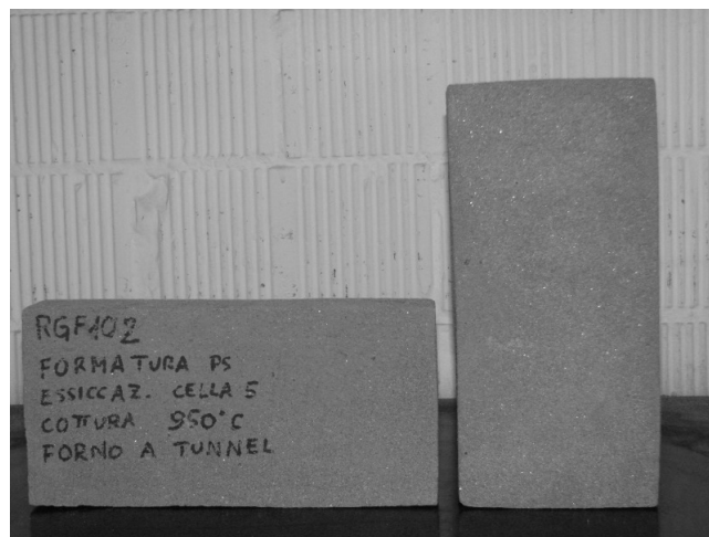
Figura 3.2: Mattoni realizzati con stampaggio manuale.
