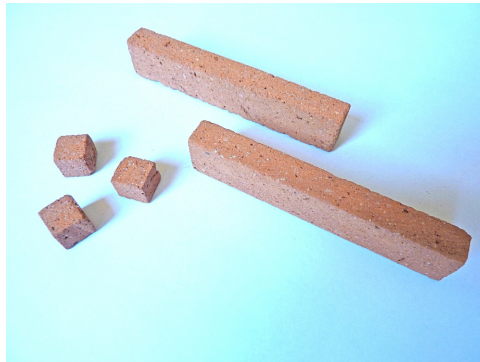
Figura 3.9: Campioni testati all'Università (provini cubici e listelli).
