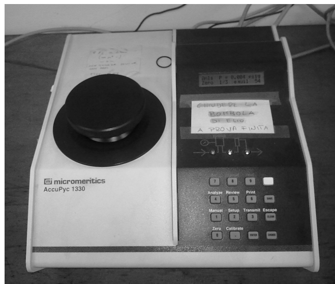
Figura 2.11: Picnometro utilizzato per le analisi di porosità.
