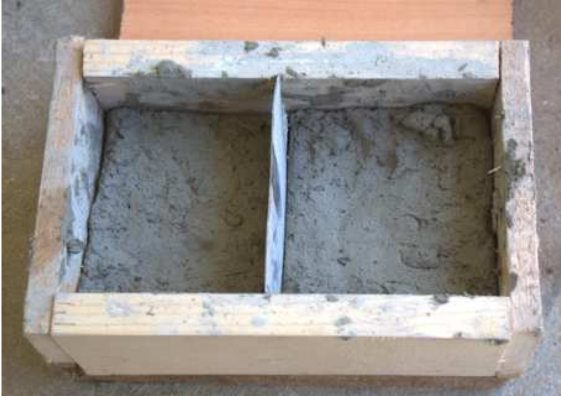
Fig. 30 - La cassetta di legno usata per dare la prima forma alla mattonella usata per l'esperimento di cottura (fotografia di Stefano Bonusi, 2023).
