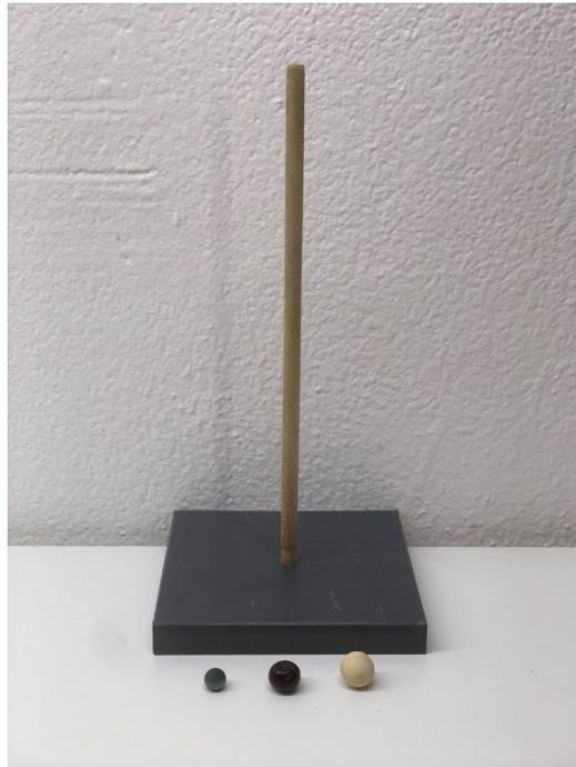
*Figura 11. Collettore e diverse particelle utilizzate nell'esperimento.*
