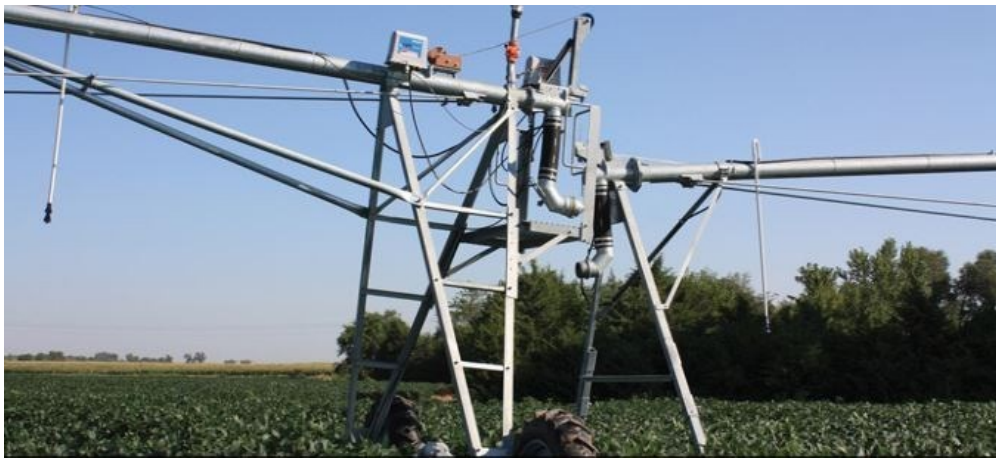
Figura 2.9: sistema drop span
