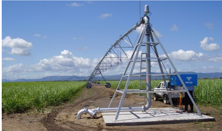
Figura 2.3: torre centrale di comando
