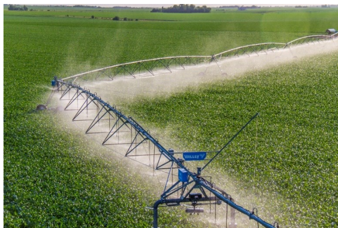
Figura 2.8: esempio di sistema corner
