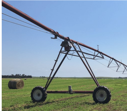
Figura 2.7: avanzamento pivot mediato da motori elettrici
