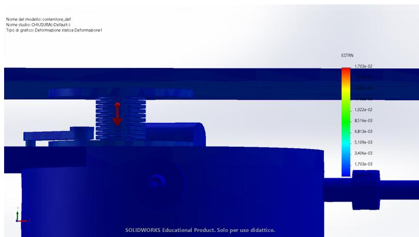
Figura 7.7: Analisi statica in posizione di chiusura, deformazione
