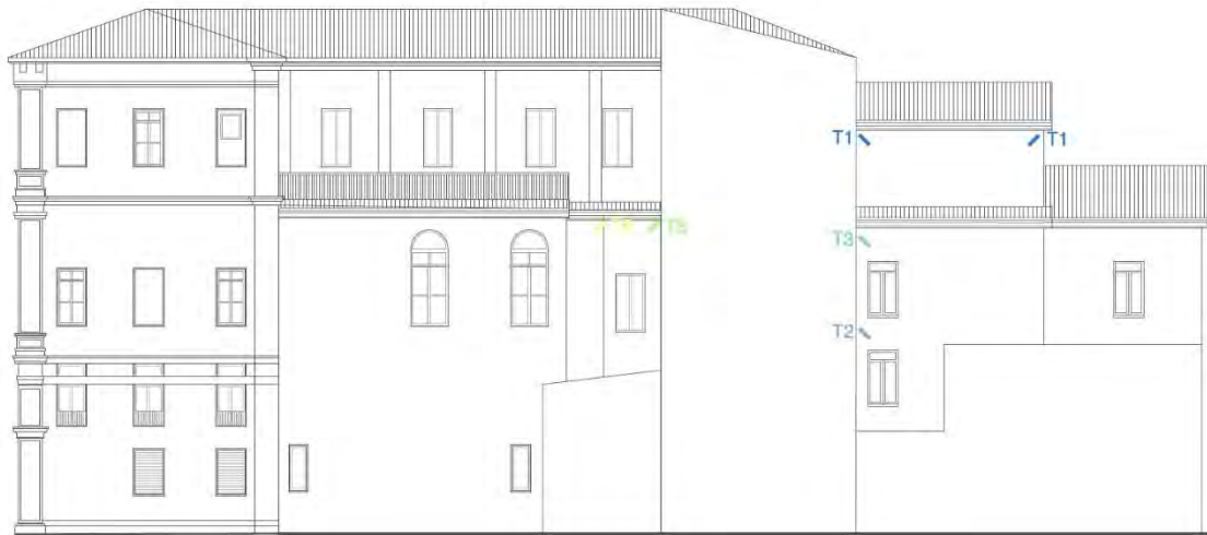
Figura 11.5: Schematizzazione della posizione dei tiranti, prospetto occidentale
