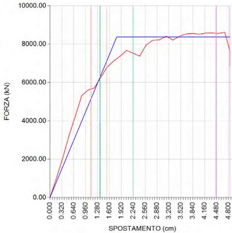
Figura 9.109: Curva di capacità dell'analisi più gravosa in direzione Y, analisi 11
