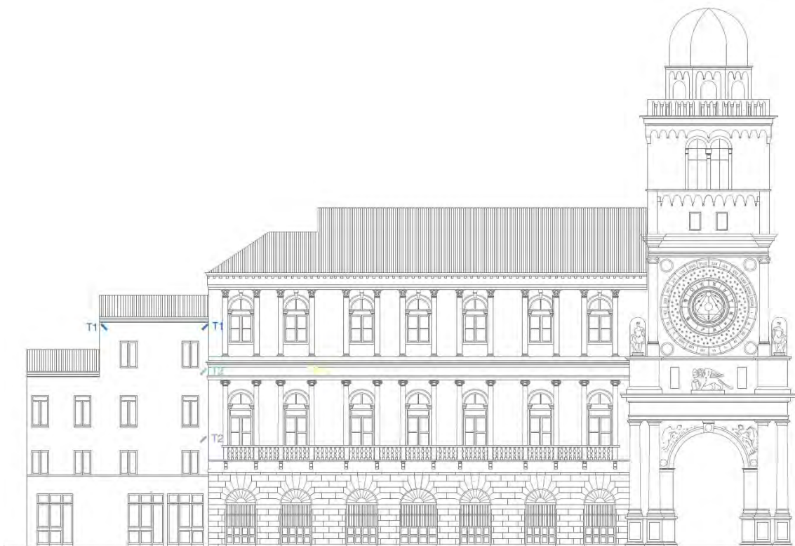
Figura 11.4: Schematizzazione della posizione dei tiranti, prospetto orientale
