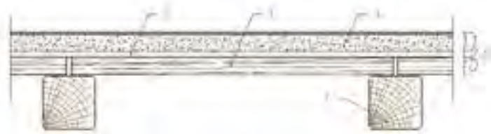
Figura 5.3: Solaio ligneo con doppio tavolato
