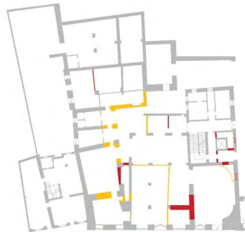
Figura 2.24: Progetto del piano terra risalente al periodo 1958-1977 e relativa comparazione della porzione relativa a Palazzo del Capitano rispetto il documento precedente
