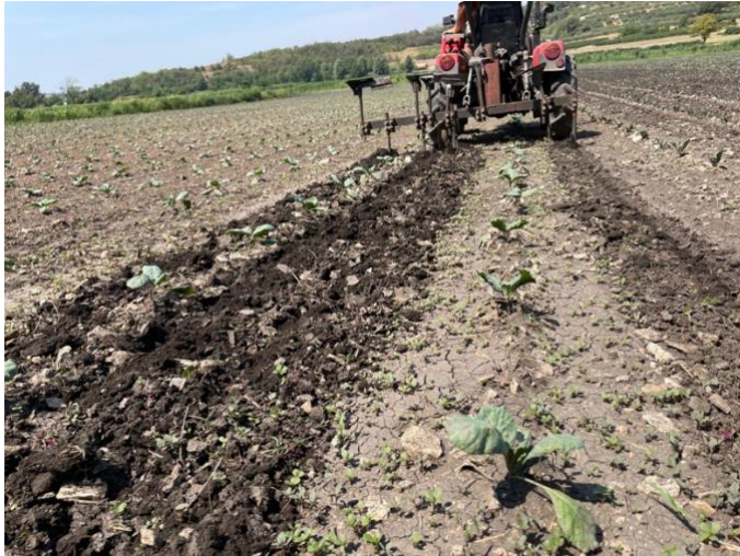
Figura 27 Sarchio artigianale dotato di zappette fisse per l'eliminazione delle malerbe nell'interfila.
