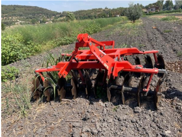
Figura 24 Frangizolle a dischi dentati utilizzato per le minime lavorazioni del terreno
