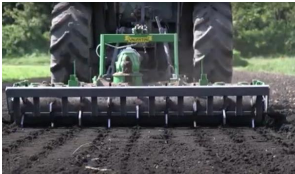
Figura 25 Erpice rotante dotata di rullo compattatore per preparazione letti di semina dei vari ortaggi.
