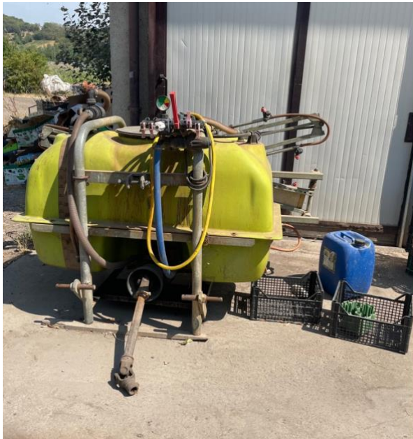
Figura 26 botte da diserbo a barre meccaniche mobili, utilizzata dal proprietario esclusivamente per la fertirrigazione
