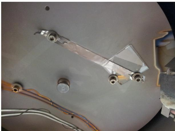
Figura 5.9: substrato di vetro posizionato per la deposizione del film.
