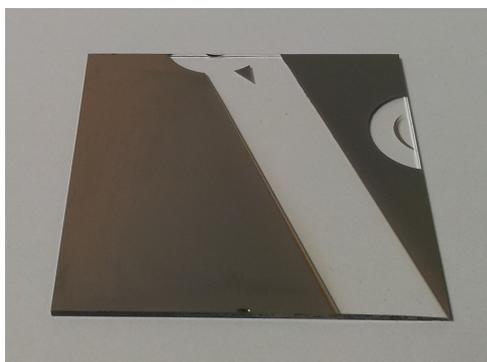
Figura 6.24: risultato della nona deposizione, MgF<sub>2</sub> su Al.
