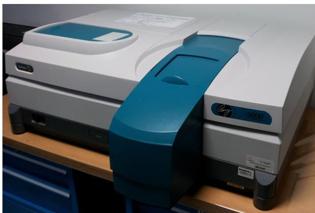
Figura 5.17: spettrofotometro per l'analisi di riflettività dei film depositati.
