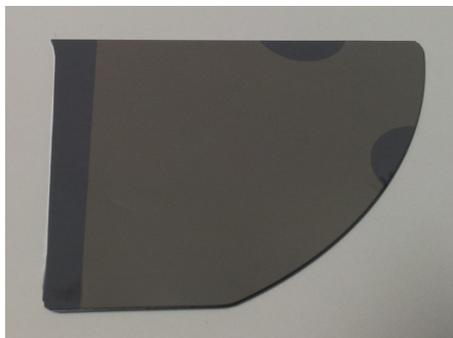
Figura 6.1: risultato della prima deposizione di Cr.
