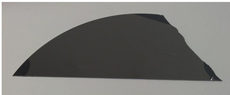
Figura 6.7: risultato della terza deposizione di Cr.
