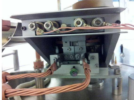
Figura 5.4: fronte del cannone elettronico e relativi conduttori di alimentazione.
