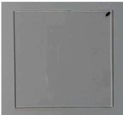
Figura 6.14: risultato dell'ottava deposizione,  $\text{MgF}_2$  su vetro.
