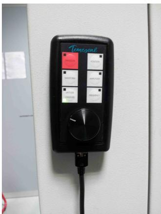
Figura 5.7: paddle per la regolazione della posizione del fascio di elettroni sul target.
