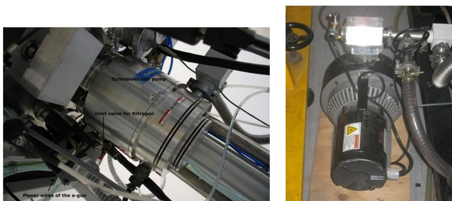
Figura 5.5: a sinistra, pompa turbomolecolare per il vuoto spinto; a destra, pompa scroll per il vuoto iniziale necessario al funzionamento della pompa turbomolecolare.
