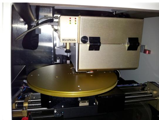
Figura 5.14: sistema di rilevazione del profilometro.
