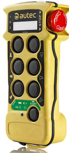
Figura 2.18: Radiocomando industriale con funzioni di sicurezza. Si noti come il pulsante di arresto di emergenza, in questo caso, è chiaramente identificabile perchè posto in modo disgiunto rispetto a tutti gli altri pulsanti, sulla parte destra del dispositivo.
