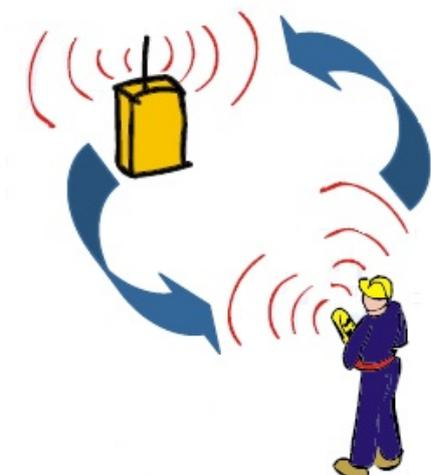
Figura 2.13: Un trasmettitore può comunicare solamente con un'unità ricevente ad esso associata per motivi di sicurezza nella radiocomunicazione.
