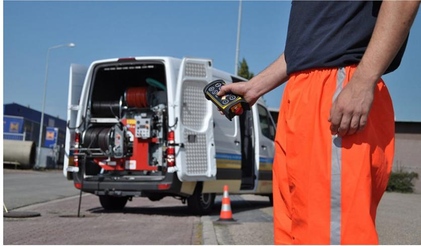
Figura 1.11: Tipico utilizzo di un radiocomando industriale.
