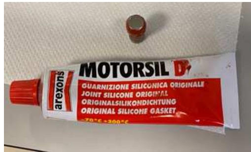
Figura 2.7: Motorsil D, il silicone utilizzato per l'isolamento dei campioni. È un elastomero monocomponente di tipo acetico.
