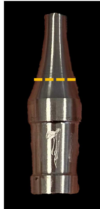
Figura 2.6: Esempio di taglio (linea tratteggiata in giallo) lungo una sezione. La porzione in alto è stata successivamente scartata.
