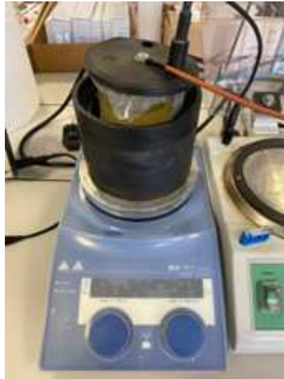
Figura 2.5: Configurazione finale del setup. Il becher è inserito all'interno del serbatoio e immerso nell'acqua.
