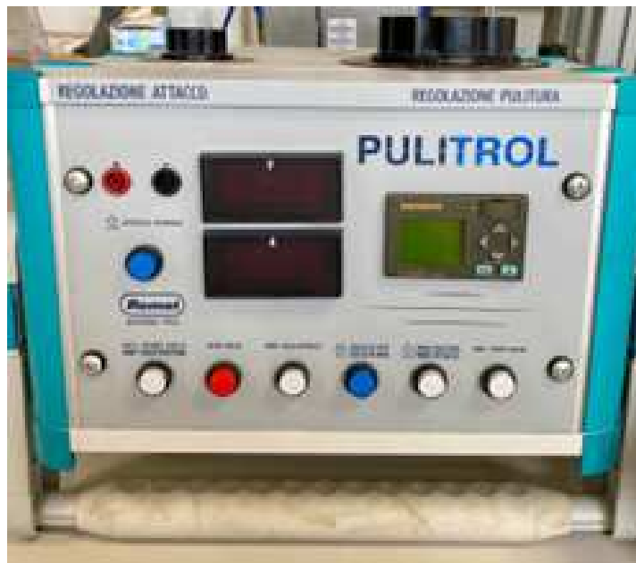
Figura 2.2: Unità di controllo della pulitrice elettrochimica. Sono visibili i due display per il monitoraggio del voltaggio e della corrente (a sinistra) e di un'interfaccia per impostare i tempi di processo, tramite pulsantiera analogica (a destra). Visibile in alto a destra, inoltre, è la manopola per regolare il valore di tensione
