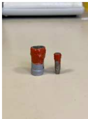
Figura 2.8: Campioni adattati alla sperimentazione. A sinistra, un esemplare della prima famiglia. A destra, uno della seconda (pin dentali). Sono visibili, in alto per entrambi i campioni, le aree esposte al processo di EP.
