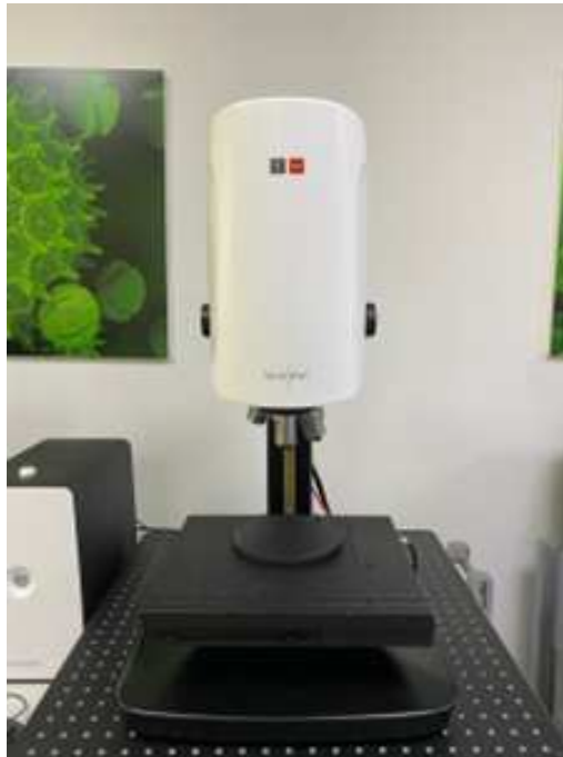
Figura 2.9: Profiometro ottico SENSOFAR "S Neox", situato alla sede di Rovigo dell'Università degli Studi di Padova.
