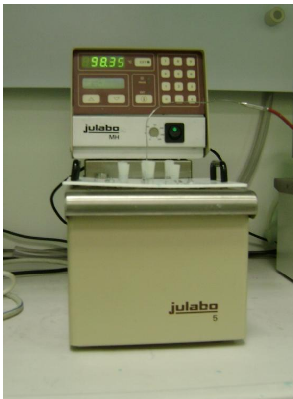
Figura 5.3: il bagno termostatico di tipo Julabo; il cavo rosso visibile in figura è la termoresistenza per il monitoraggio della temperature del sistema
