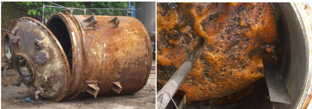
Figura 2.8: foto effettuate dopo l'incidente (a) il miscelatore T18, (b) il contenuto del miscelatore
