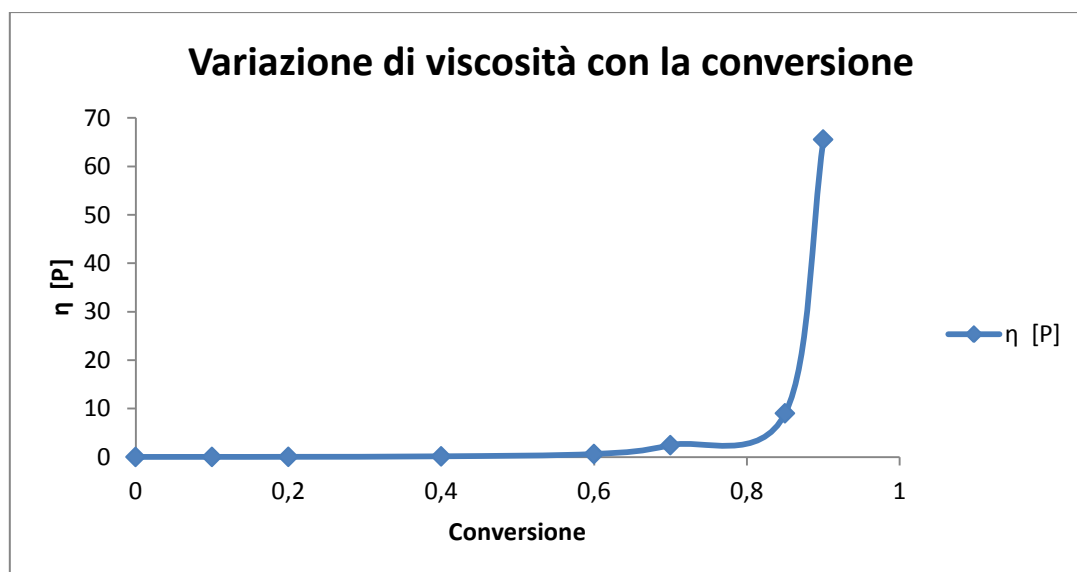
Figura 4.2: andamento della viscosità con conversione crescente
