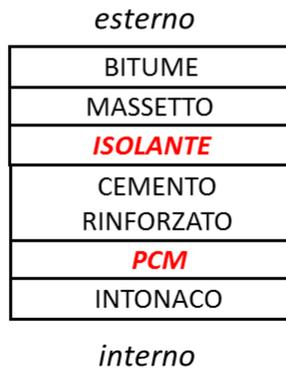
*Figura 5.4: Stratigrafia del tetto piano*
