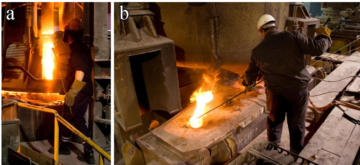
Figura 2.9. a) Prelievo di un campione di acciaio dal forno siviera e b) dalla paniera
