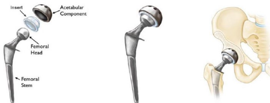
Figura 2.2. Componenti della protesi totale d'anca e loro posizionamento [33]
