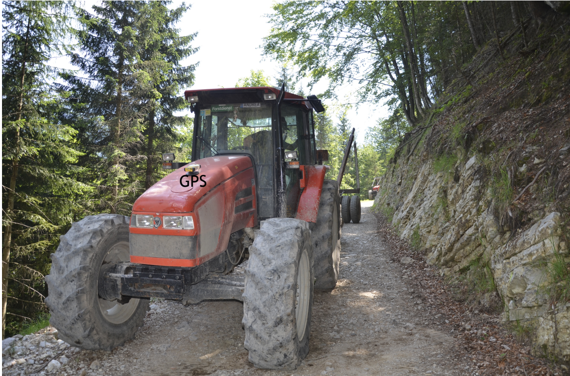
Figura 2.18: installazione dell'antenna GPS sulla trattrice.
