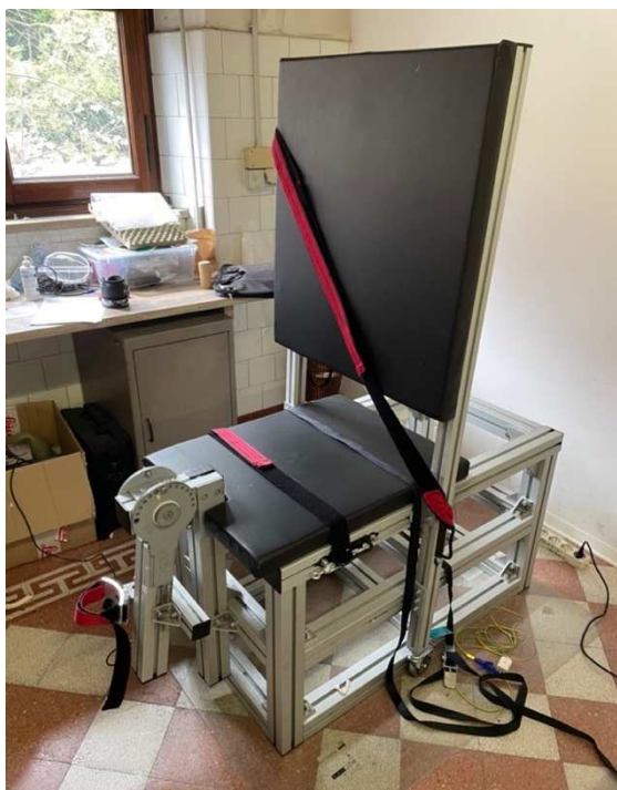
Figura 4. Dinamometro isometrico utilizzato durante la valutazione neuromuscolare, atto a misurare la forza volontaria massima e submassimale isometrica attraverso l'estensione del ginocchio.
