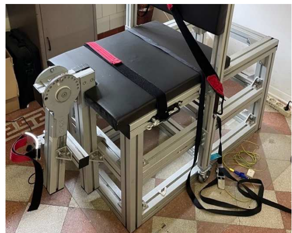
Figura 4. Dinamometro isometrico utilizzato durante la valutazione neuromuscolare, atto a misurare la forza volontaria massima e submassimale isometrica attraverso l'estensione del ginocchio.
