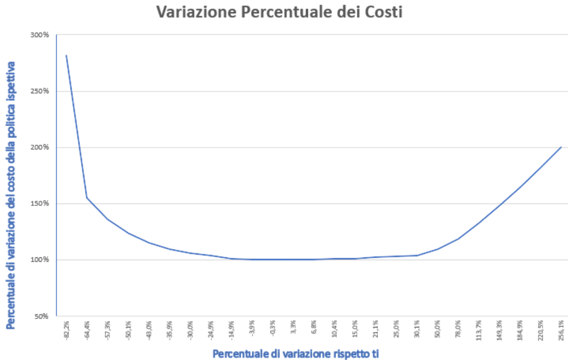
Figura 45 - Variazione percentuale dei costi della politica ispettiva in funzione della variazione di t_i
