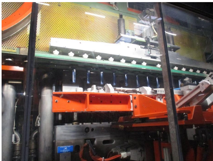
Figura 34 - Macchina per la realizzazione delle preforme in PET
