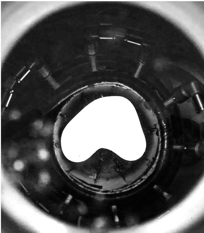
Figura 33 – Vista dalla finestra superiore della camera a vuoto del metallo fuso mantenuto in levitazione nel crogiolo
