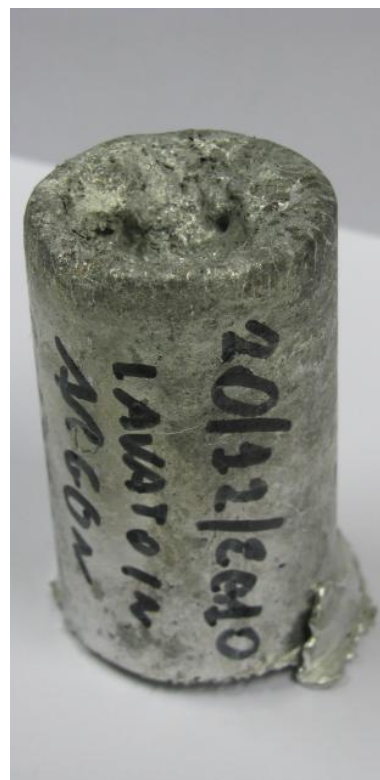
Figura 32 – Campione colato in pressione di argon dopo diversi lavaggi della camera a vuoto
