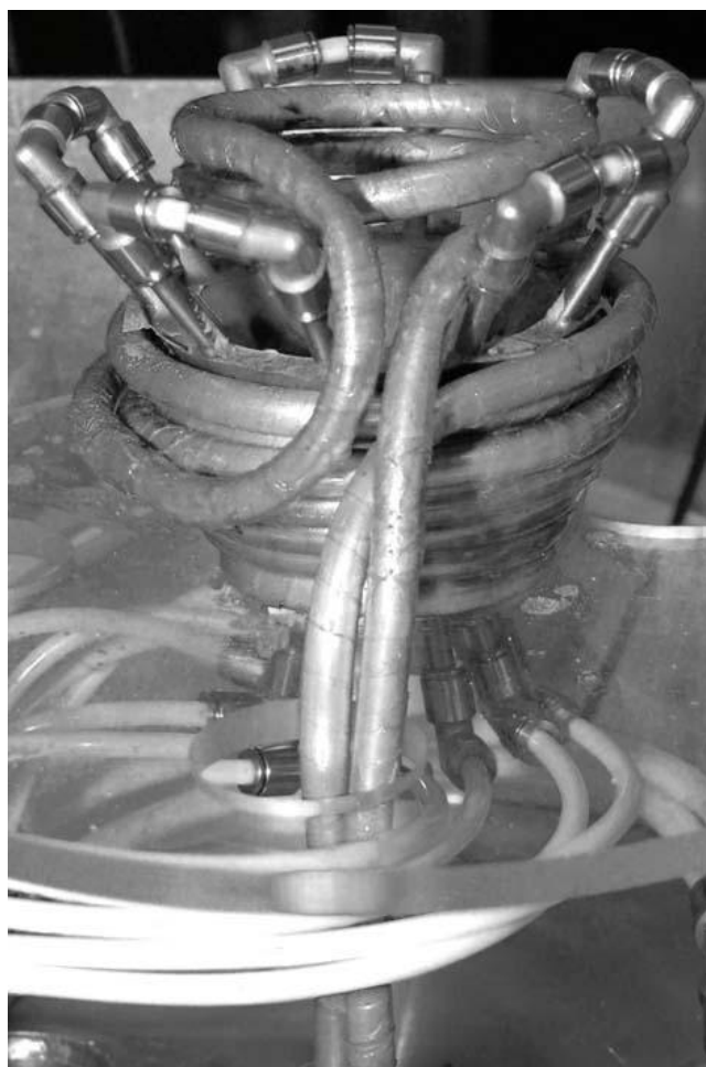
Figura 26 – Il conduttore avvolto attorno al crogiolo
