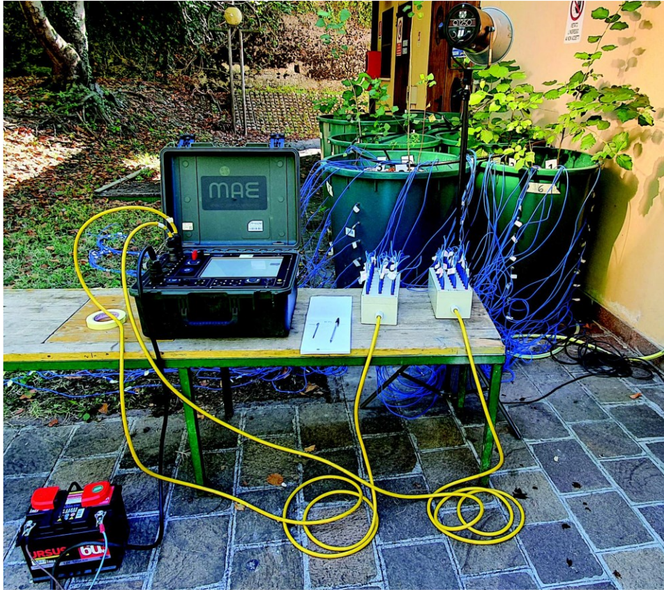
Figura 14: Installazione georesistivimetro per la misura ERT. Foto della Dott.ssa Sartori.
