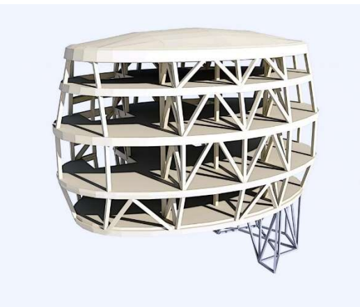
Figura 17: struttura portante del Rifugio Gouter
