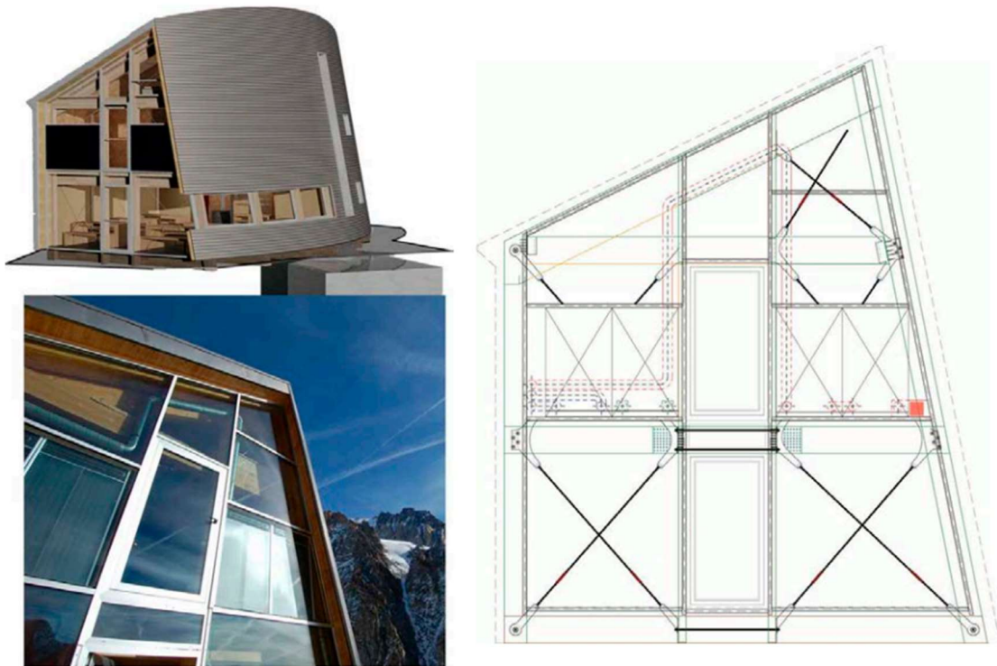
Figura 31: Schema controventi in acciaio sulle vetrate del Rifugio Gonella
