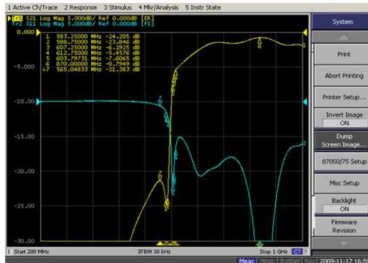
Figura 6.13: Modulo della risposta in frequenza ( $s_{21}$ ) e di  $s_{11}$  del prototipo planare in esame, con l'induttore di figura 6.12 tarato in posizione 1 da destra. Come si vede, questa posizione di taratura consente di tagliare proprio in corrispondenza del canale 35.
