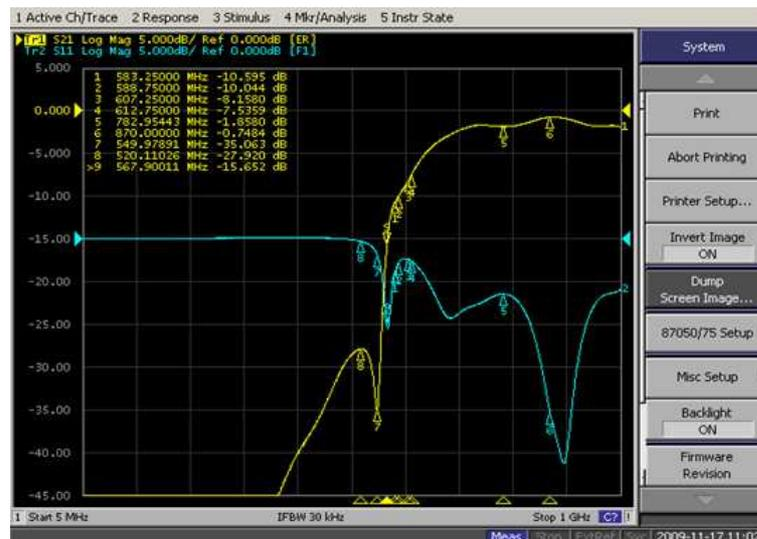
Figura 6.5: Modulo della risposta in frequenza ( $s_{21}$ ) e di  $s_{11}$  del prototipo di figura 6.3 (a), il quale presenta un *notch* planare formato dalla serie  $1pF$   $0805 + L = 42nH$   $N = 1.5$  tarabile con bassa risoluzione (5 taratori predisposti in fase di progetto).
