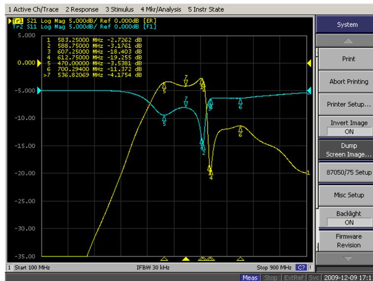
Figura 6.23: Modulo della risposta in frequenza ( $s_{21}$ ) e  $s_{11}$  del prototipo planare di figura 6.20 accordato all'ottimo.
