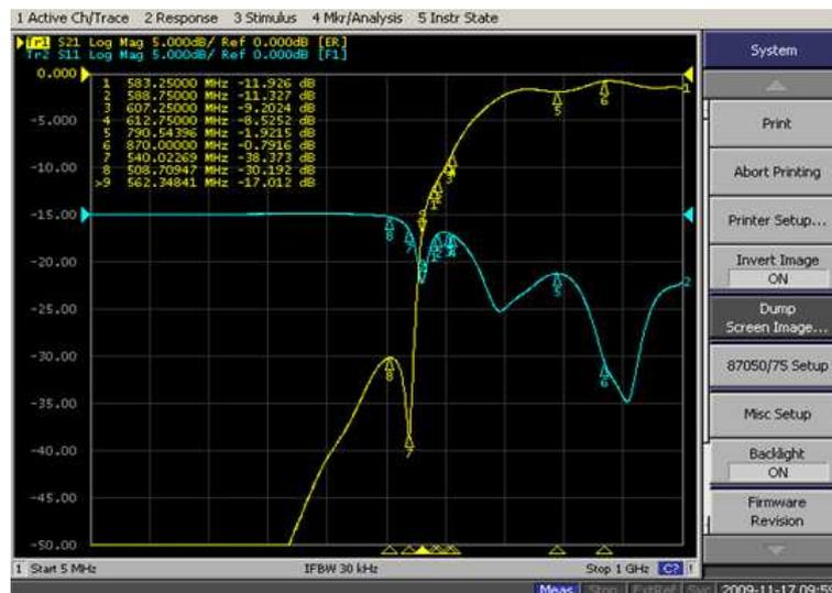
Figura 6.4: Modulo della risposta in frequenza ( $s_{21}$ ) e di  $s_{11}$  del prototipo di figura 6.2, il quale presenta un *notch* planare formato dalla serie  $1pF$  0805 +  $L = 42nH$   $N = 1.5$  non tarabile.
