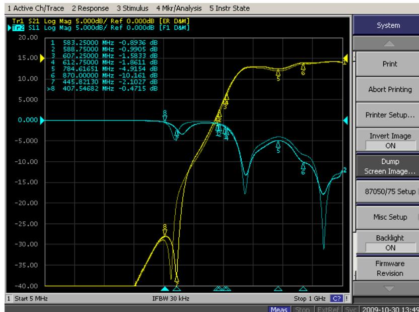
Figura 4.9: Andamento del modulo della risposta in frequenza ( $s_{21}$ ) e di  $s_{11}$  (rispettivamente in giallo marcato e azzurro marcato) del filtro banda V con il *notch* formato dalla serie del condensatore da  $1pF$  0805 e di un induttore da  $100nH$  1008. In giallo tenue ed in azzurro tenue sono riportati rispettivamente il modulo di  $s_{21}$  e di  $s_{11}$  del prototipo di base con l'induttore planare da 2 spire di figura 4.4.
