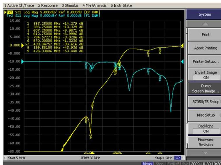
Figura 4.8: Modulo della risposta in frequenza ( $s_{21}$ ) e di  $s_{11}$  del prototipo di filtro banda V di figura 4.5, caratterizzato da  $L_1=74nH$   $N = 2$  di figura 4.4.
