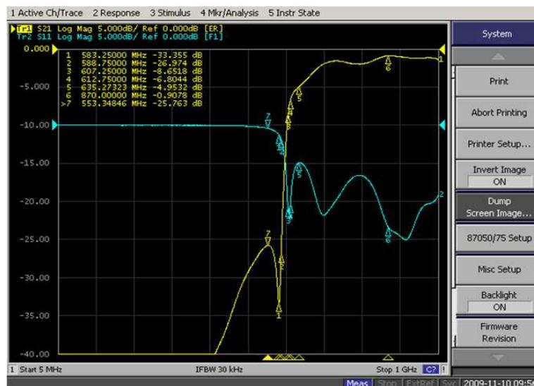
Figura 5.18: Modulo della risposta in frequenza  $s_{21}$  e di  $s_{11}$  del prototipo tarato di fig.5.17.
