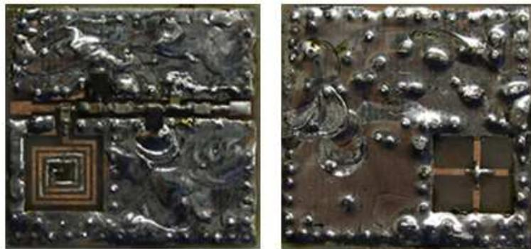
Figura 4.7: Piano top (a sinistra) e piano bottom (a destra) del prototipo di filtro banda V con  $L_1=74nH$   $N = 4$  di figura 4.4.
