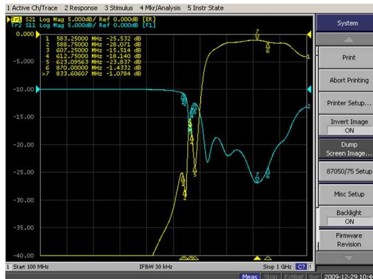
Figura 6.32: Modulo della risposta in frequenza ( $s_{21}$ ) e di  $s_{11}$  del filtro banda V con l'influenza del filtro banda IV.
