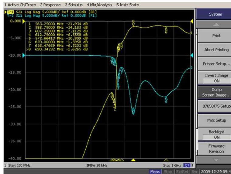
Figura 6.30: Modulo della risposta in frequenza ( $s_{21}$ ) e di  $s_{11}$  del filtro banda V senza l'influenza del filtro banda IV.
