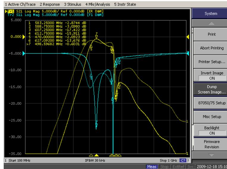
Figura 6.24: Modulo della risposta in frequenza ( $s_{21}$ ) e di  $s_{11}$  del filtro banda IV PTH a bordo del centralino dopo le operazioni di taratura. Sullo sfondo gli stessi ricavati dal prototipo planare.
