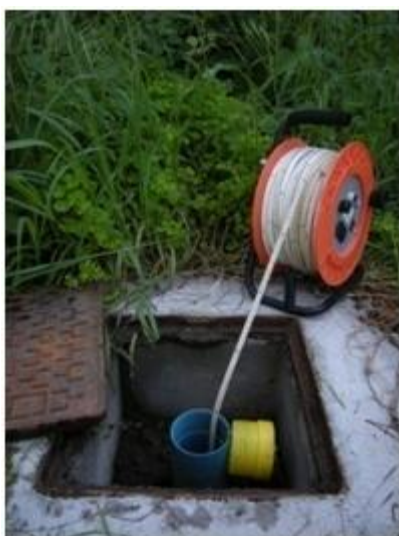
Fig. 3.3:Freatimetro con cordella metrica calato durante una misurazione della soggiacenza.
