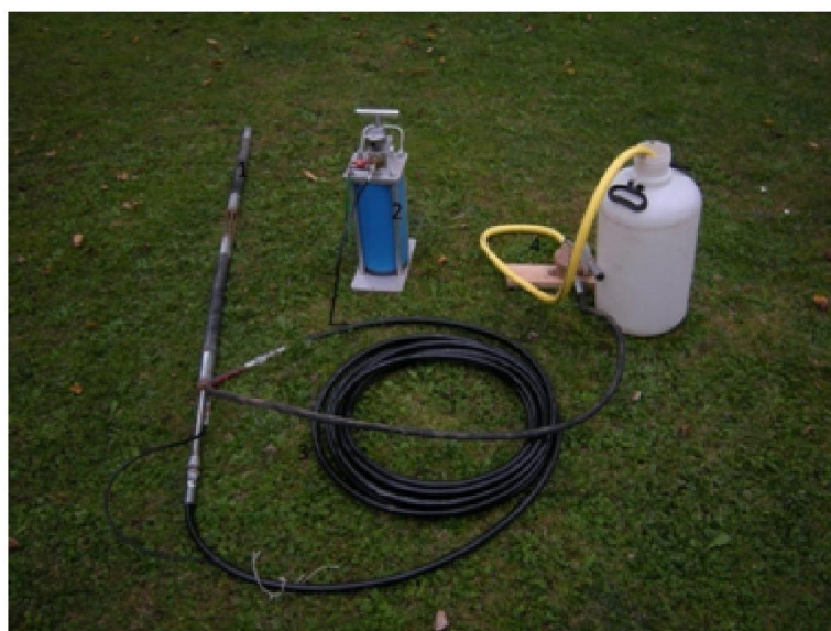
Fig.3.17: Strumentazione utilizzata per le prove di diluizione/tracciamento; il sistema è costituito da packers (1), pompa per l'iniezione dell'acqua (2), tubaggio per il trasporto della salamoia all'interno deipackers fino al tratto fenestrato (3), pompa per l'iniezione della salamoia (4).
