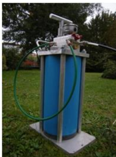
Fig.3.16: Pompa utilizzata per il gonfiaggio deipackers.
