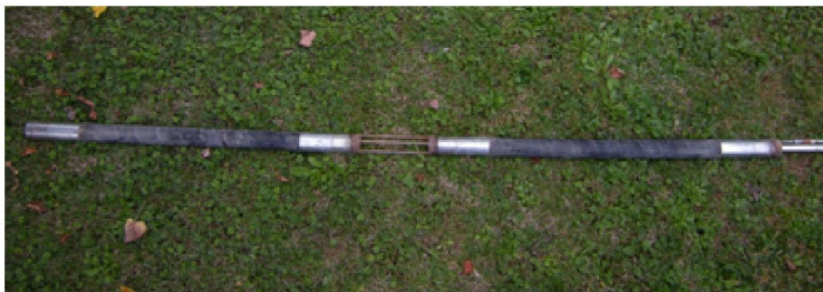
Fig.3.15: Packers, i tratti gommati neri, con la pressione dell'acqua vengono gonfiati fino ad aderire alle pareti del piezometro, bloccando il flusso lungo la verticale.
