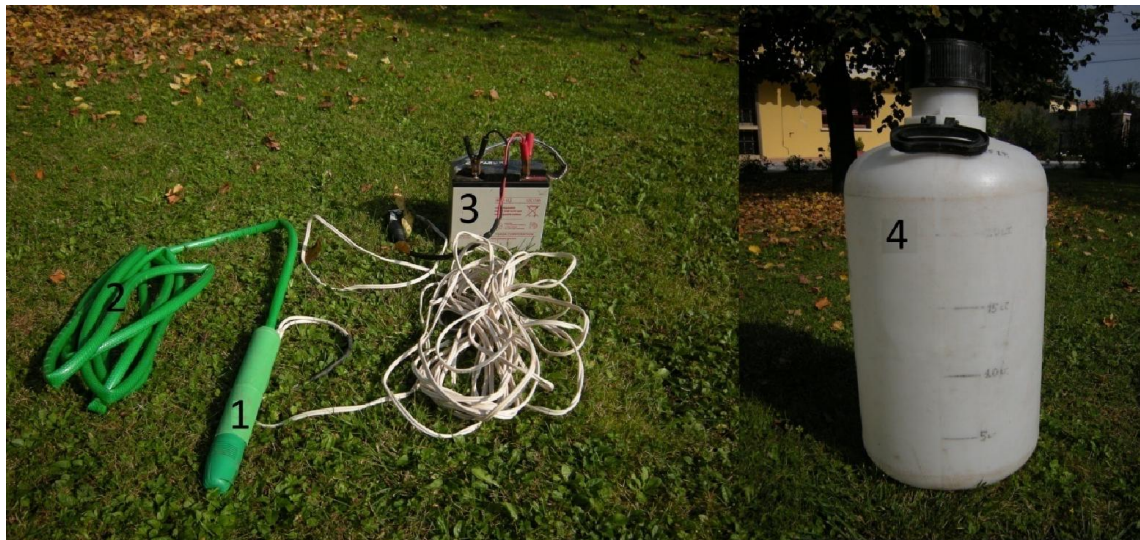
Fig.3.14: Strumentazione utilizzata per le prove di diluizione, 1: pompa ad immersione; 2: tubo con tratto fenestrato; 3: pila da 12V; 4:recipiente graduato in cui sono state preparate le soluzioni di acqua e cloruro di sodio.
