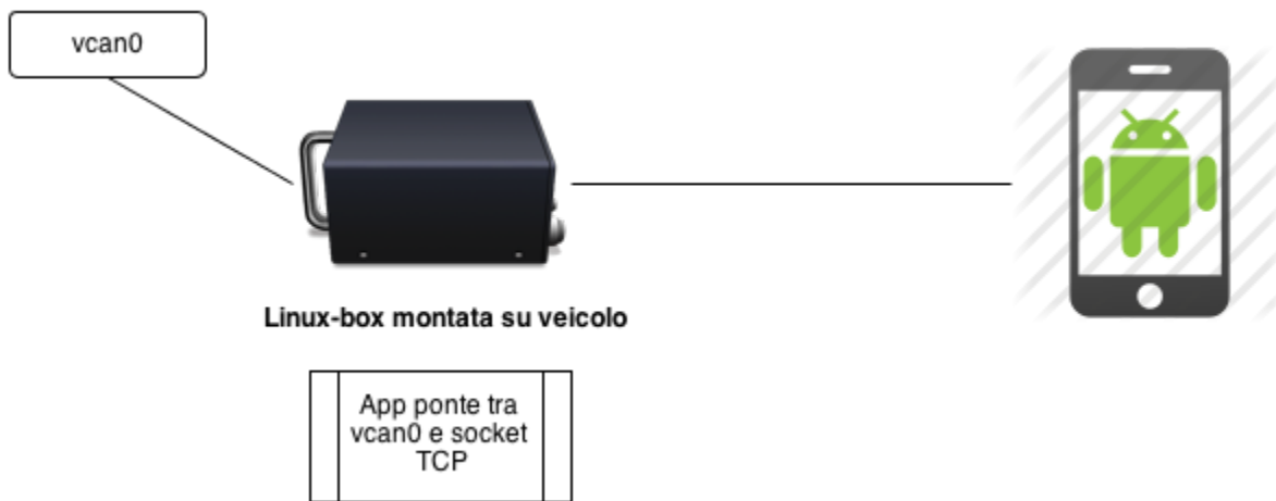
Figura 7: linux-box veicolo e Socketcan
