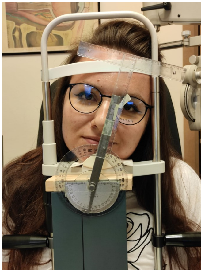
Figura 7: sistema realizzato durante il test, mento e fronte appoggiati alla mentoniera, occhiale indossato e inclinazione mantenuta durante la lettura delle C a 10^\circ .
