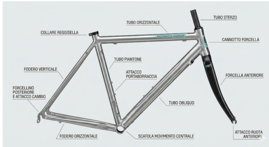
Figura 3.1: Riquadro dei componenti del telaio
