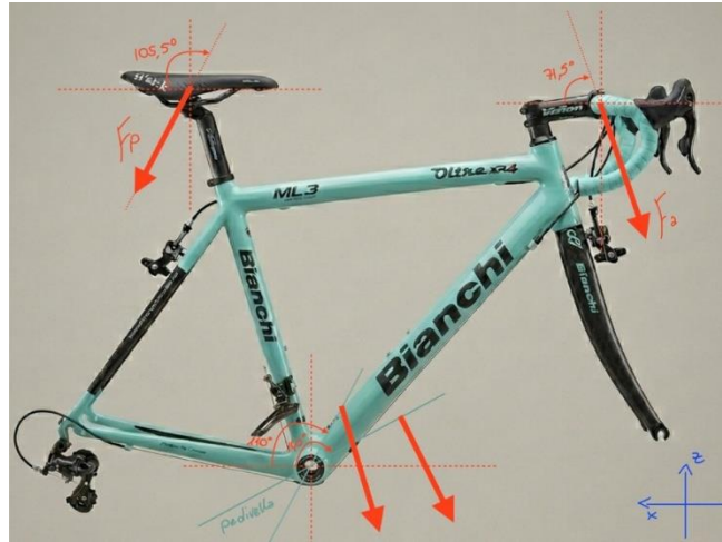
Figura 3.4: Inclinazione delle principali forze agenti
