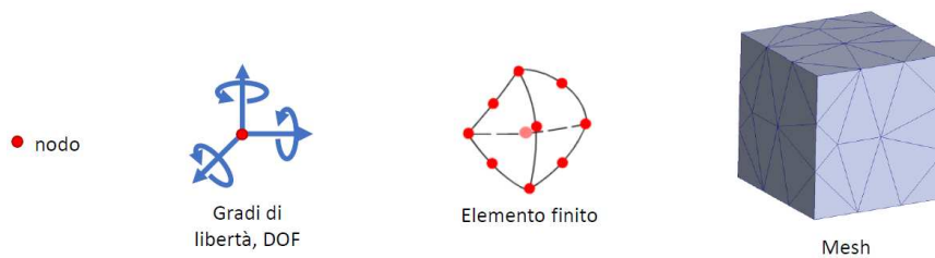
Figura 5.0: Elementi di base dell'analisi FEM
