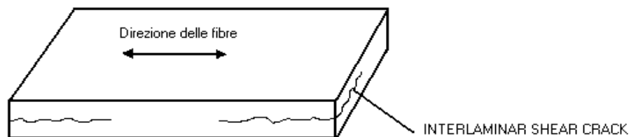
Fig. 5.1 Cracking interlaminare a seguito della prova ILSS
