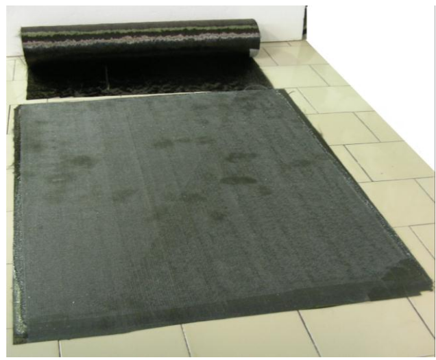
Fig. 5.2 Laminato prima post-curing
