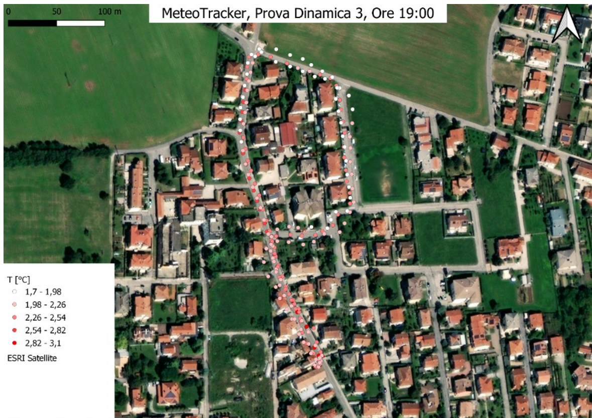
Figura 40 – Carte prove dinamiche, valori di temperatura registrati dal MeteoTracker
