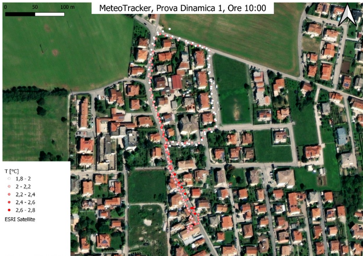
Figura 19 – Carte prove dinamiche, valori di temperatura registrati dal MeteoTracker
