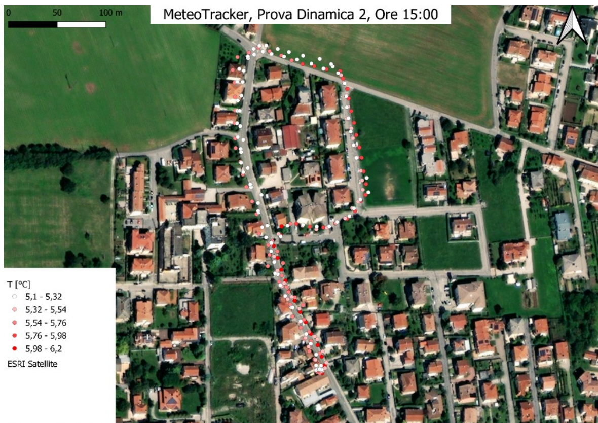
Figura 36 – Carte prove dinamiche, valori di temperatura registrati dal MeteoTracker
