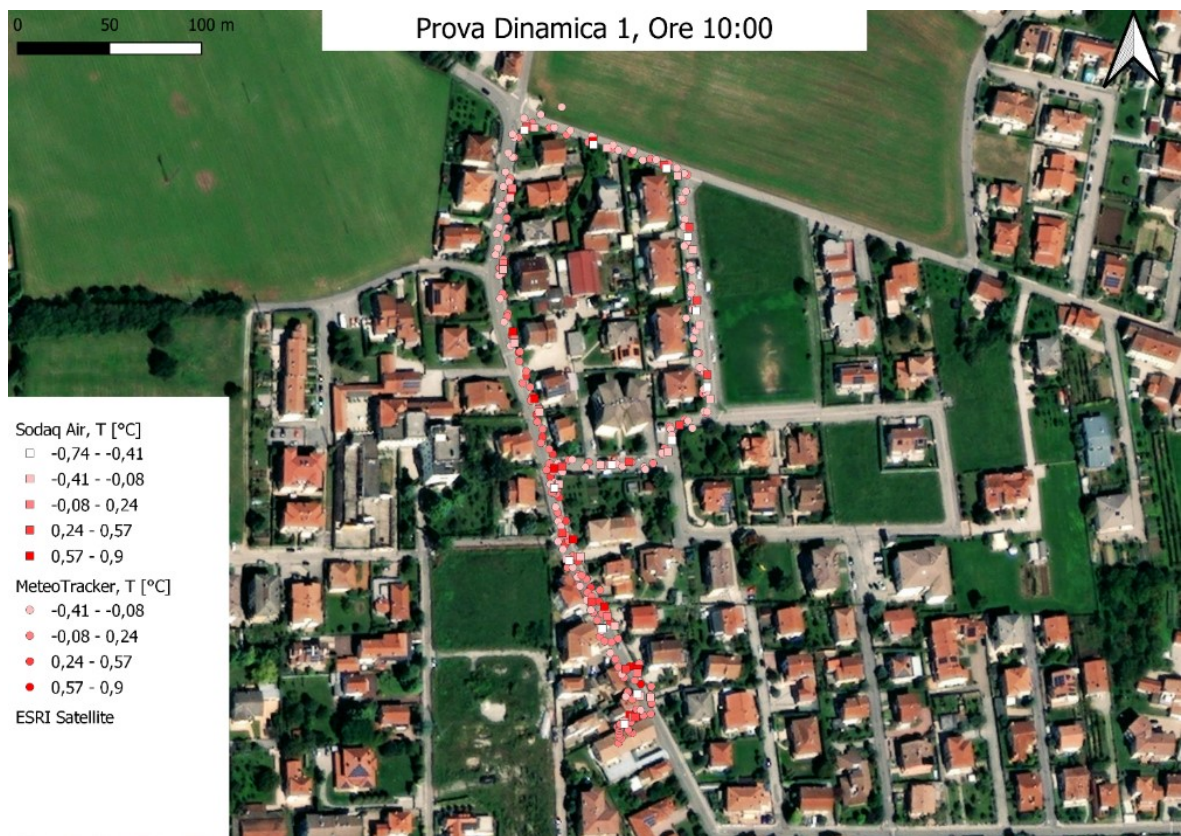
Figura 20 – Carte prove dinamiche, valori di temperatura registrati dal MeteoTracker e dal Sodaq Air. Riportati i delta T rispetto alla temperatura media della sessione di prova
