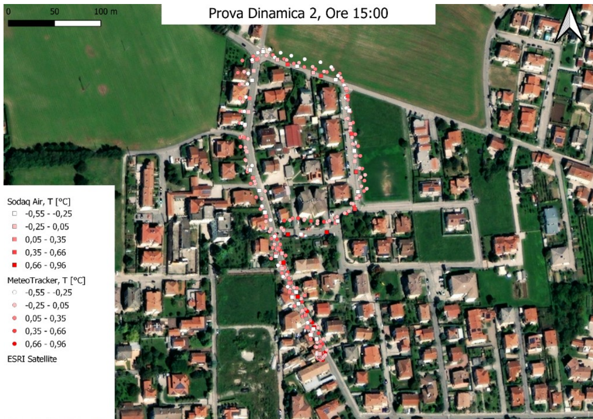
Figura 37 – Carte prove dinamiche, valori di temperatura registrati dal MeteoTracker e dal Sodaq Air. Riportati i delta T rispetto alla temperatura media della sessione di prova
