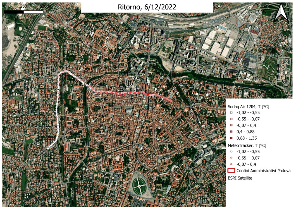
Figura 28 – Carte sessioni selezionate a Padova, valori di temperatura nel tratto di ritorno registrati dal MeteoTracker e Sodaq Air. Riportati i valori di delta T rispetto alla temperatura media della sessione
