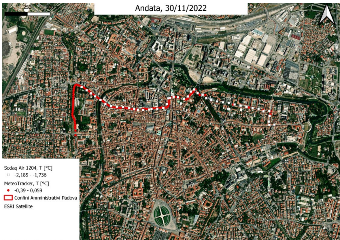
Figura 45 – Carte sessioni selezionate a Padova, valori di temperatura nel tratto d’andata registrati dal MeteoTracker e Sodaq Air. Riportati i valori di delta T rispetto alla temperatura media della sessione
