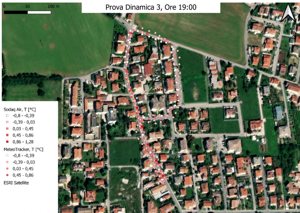
Figura 41 – Carte prove dinamiche, valori di temperatura registrati dal MeteoTracker e dal Sodaq Air. Riportati i delta T rispetto alla temperatura media della sessione di prova
