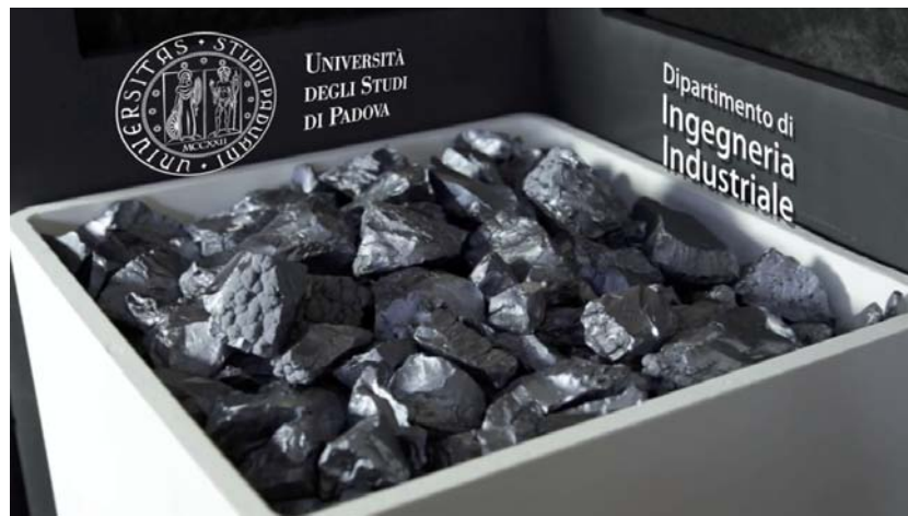
Figura 2.18: Carico di silicio in chunks, produttore: Targray.
