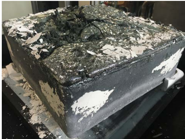
Figura 6.16: Lingotto ottenuto dopo la fusione con il forno iDSS
