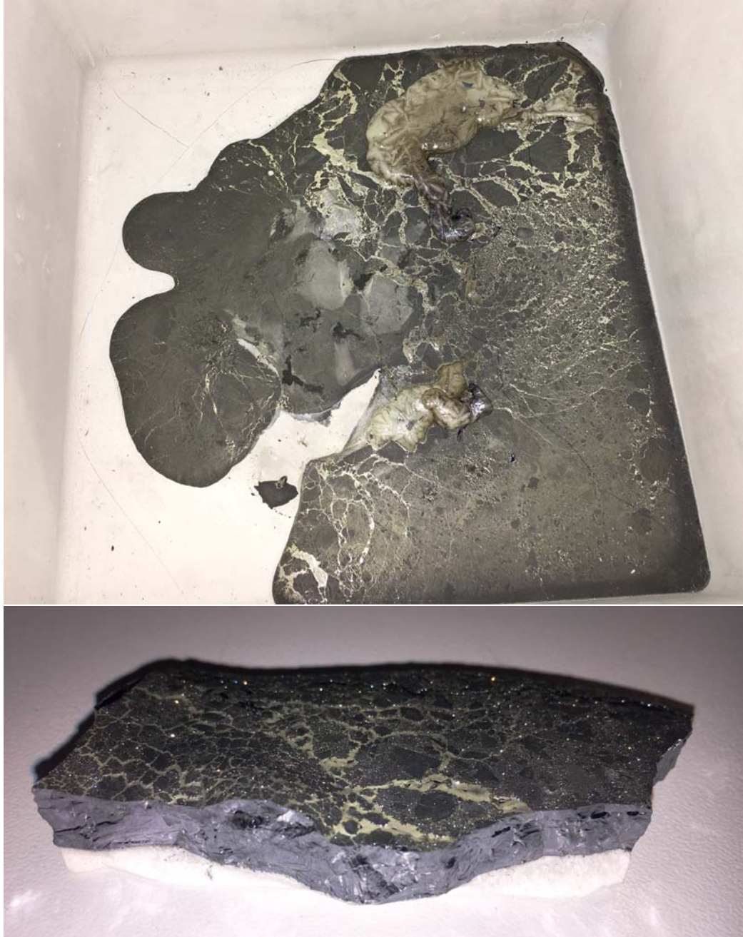
Figura 6.7: Silicio dopo la fusione: sopra all'interno del crogiolo, sotto un particolare
