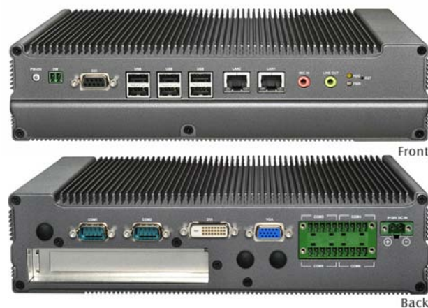
Figura 3.3: LEC-2010 PC industriale che esegue il linguaggio ST
