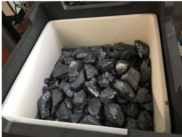
Figura 6.15: Carico di 60kg di silicio prima della fusione
